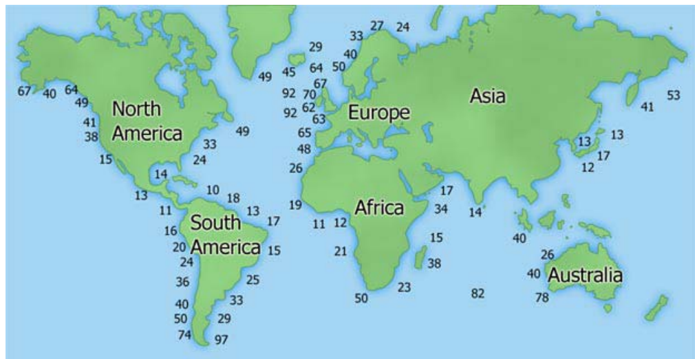
Kuva 3. Energian jakautuminen ympäri maailman kW/m leveysmetrillä. /3/
