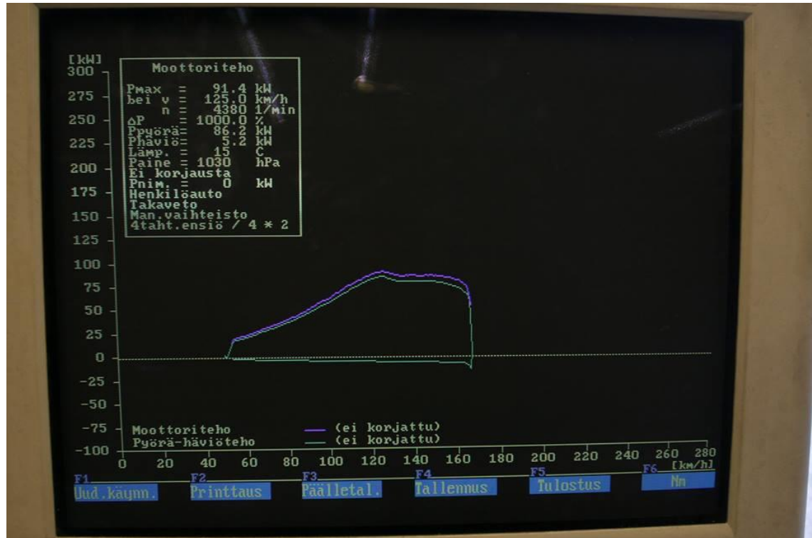
Kuva 10.4 Saavutettu moottoriteho 160 kPa:n paineella
