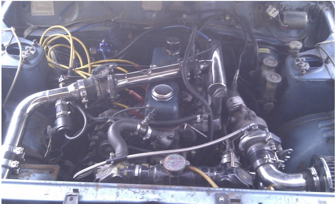
Kuva 10.3 Turboahtimen sijoitus ja valmis asennus
