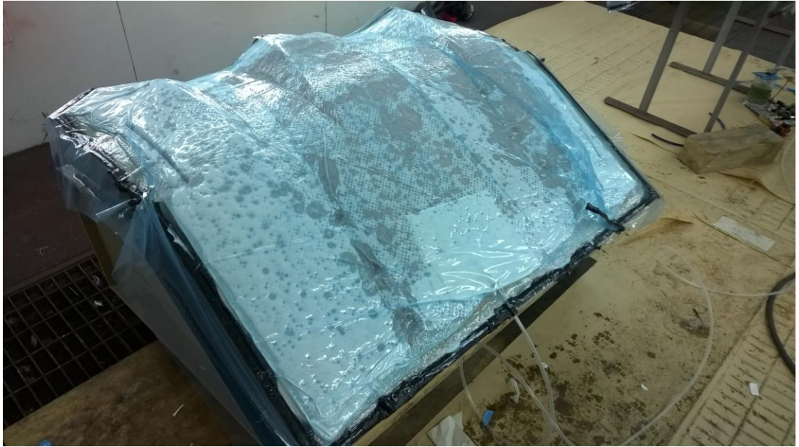
Kuva 34. Alipaineeseen imetty suurempi muotti.
