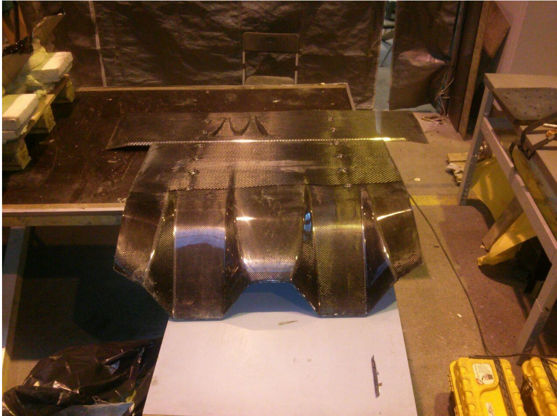
Kuva 48. Diffuusori ja pohjalevy karkeasti leikattuna injektoinnin jälkeen.
