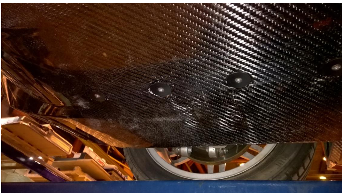
Kuva 49. Diffuusori kiinnitettynä polyasetaalikartioilla autoon.
