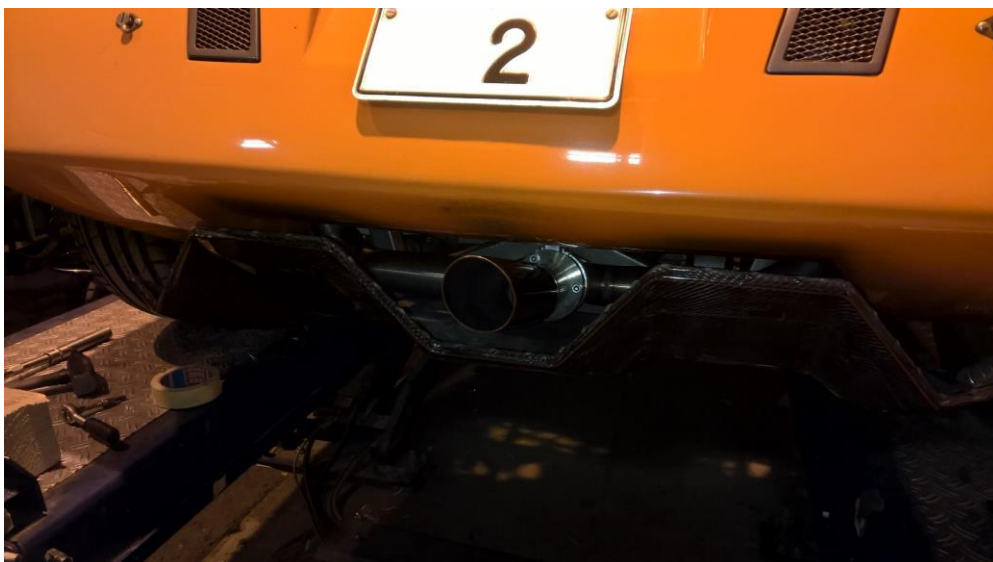
Kuva 60. Diffusori ja pakoputki asennettuna paikalleen.
