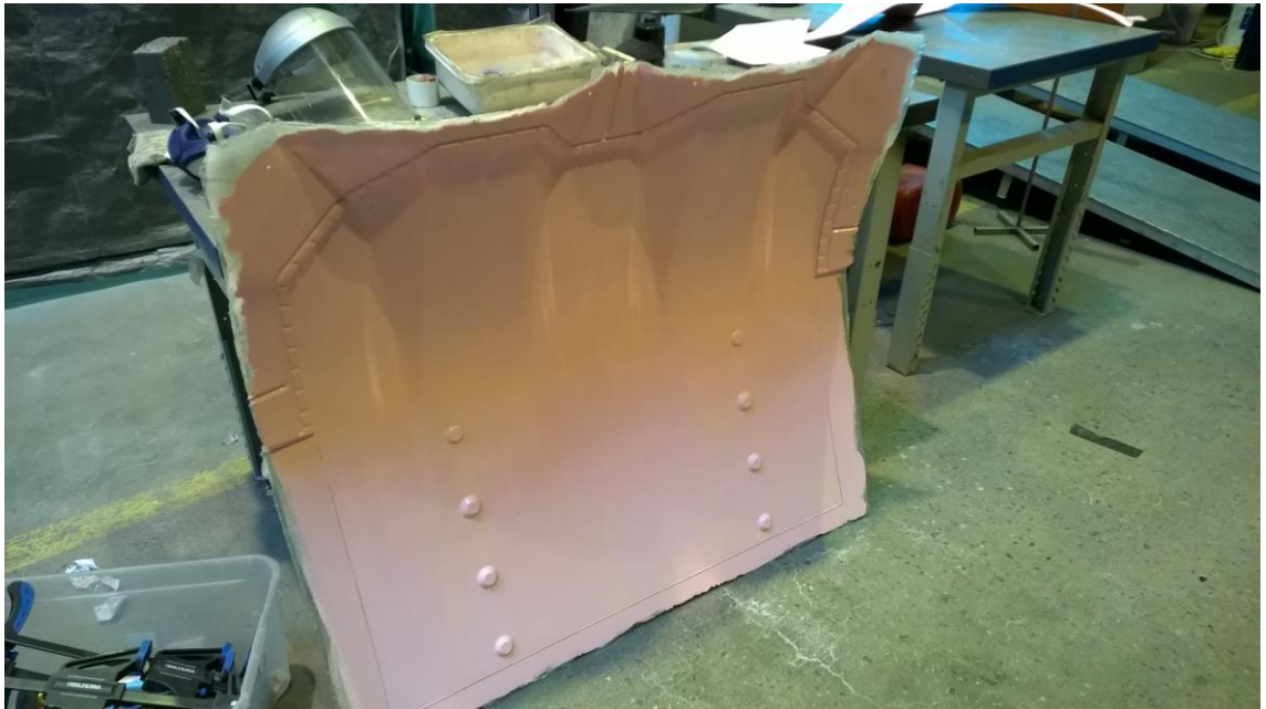
Kuva 36. Diffusorin lasikuitumuotti valmiina.
