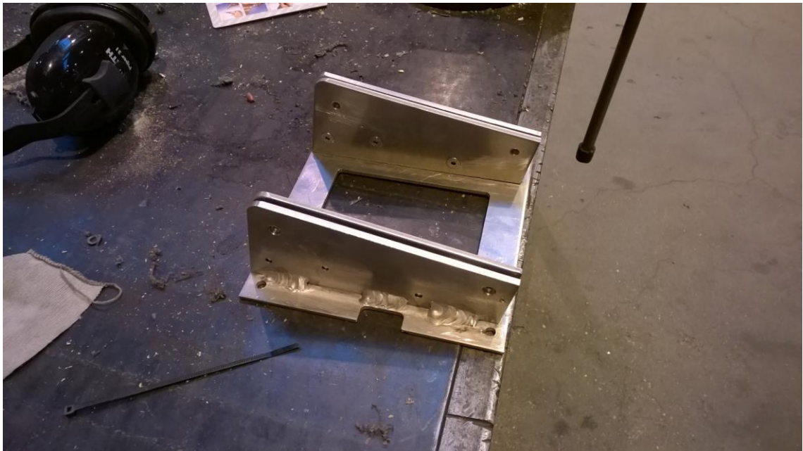
Kuva 1. Autoon kiinnitettävä teline pöydän jalaksia varten
