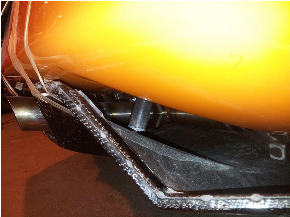
Kuva 51. Peräosan kiinnike kiinnitettynä autoon.
