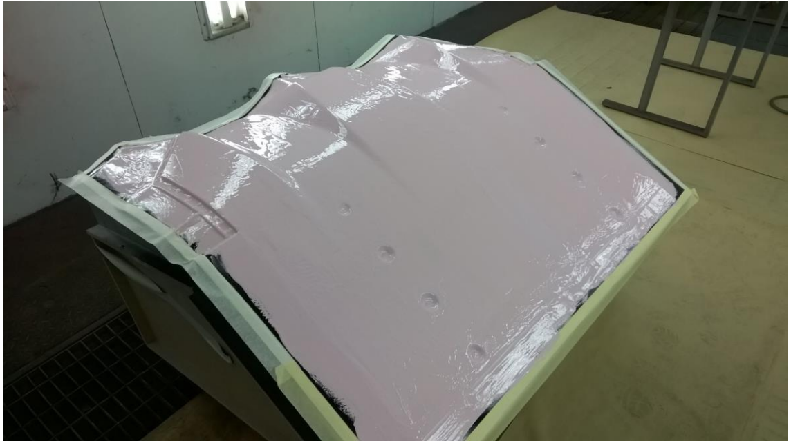
Kuva 32. Gel coat -pinnoitettu suurempi muotti.
