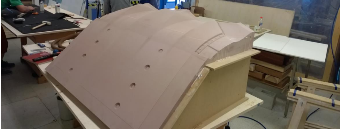
Kuva 30. Diffusorin muotin puoliskot liitettynä toisiinsa.
