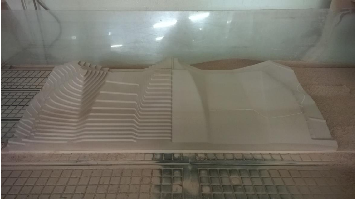
Kuva 28. Diffuusorin viimeistelyajo puolessavälissä. Vasemmalla puolella rouhinnan jälkeinen pinta ja oikealla viimeistely pinta.
