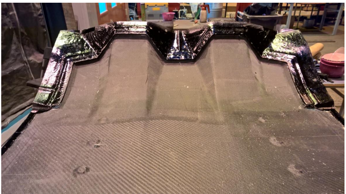
Kuva 45. Valmis diffuusori irrotettuna muoveista injektoinnin jälkeen.
