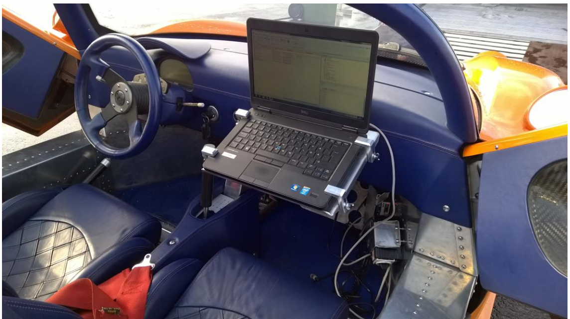
Kuva 3. Tietokone kiinnitettyä alumiinista valmistettuun pöytään koneistetuilla ”kynsillä”.
