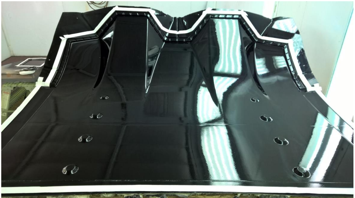
Kuva 41. Diffusori kiiltäväksi maalattuna. Laidoille kiinnitetty tiivistenauha injektointia varten.
