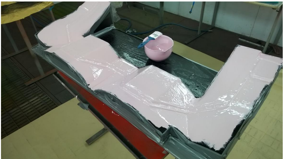
Kuva 33. Gel coat -pinnoitettu reunataitoksen muotti.
