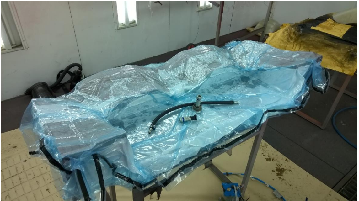
Kuva 35. Alipaineeseen imetty reunataitoksen muotti.
