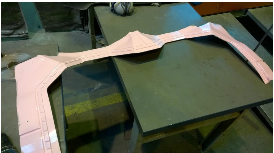
Kuva 37. Diffusorin reunataitoksen lasikuitumuotti valmiina.
