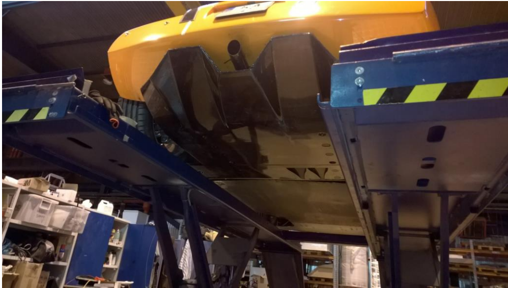
Kuva 59. Auton pohja uuden pohjalevyn ja diffusorin kanssa.
