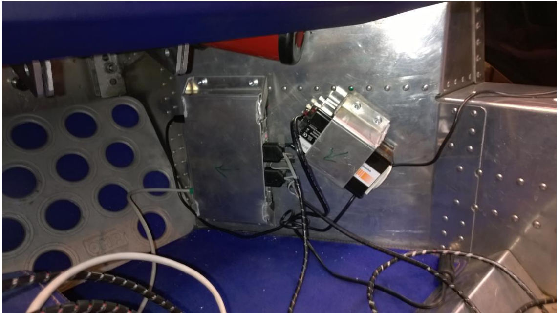
Kuva 4. Invertteri ja mx840 kiinnitettynä autoon.
