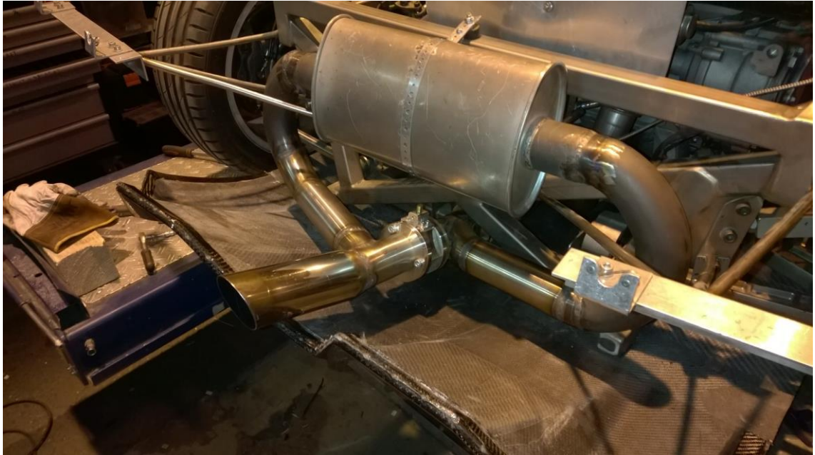
Kuva 58. Pakoputkisto valmiiksi hitsattuna ja asennettuna.
