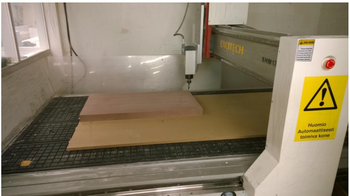
Kuva 27. Aihiot kiinnitettynä CNC-koneen pöydälle.
