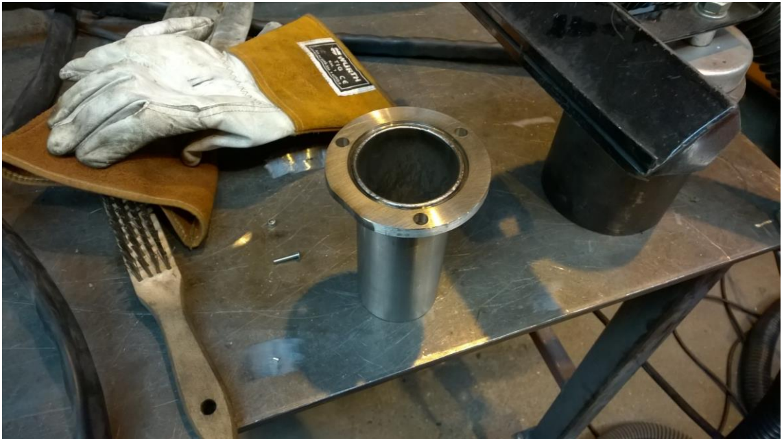
Kuva 55. Laippa hitsattuna putkeen.
