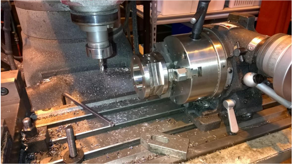
Kuva 54. Portin runko jyrsettynä jyrsinkoneessa.
