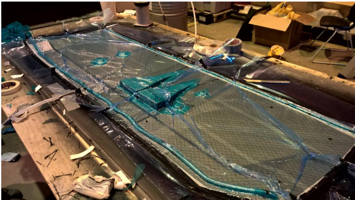
Kuva 42. Diffusorin pohjalevyosa imettynä alipaineeseen injektointia varten.
