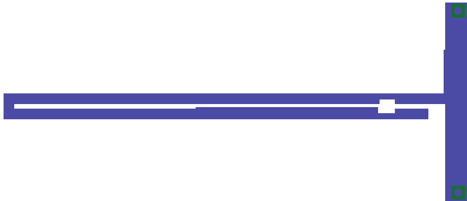
Kuva 58. Kaksipuolisen Schiffamanin-vaihesiirtäjän Piirilevykomponentti, alataso
