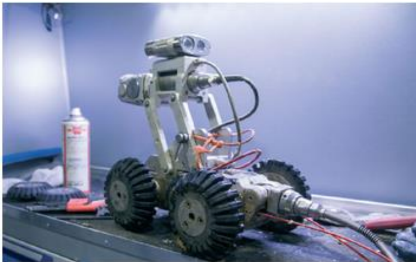
Kuva 4. Viemärin kuvausrobotti. (Kaivopumppu www-sivut 2015)
