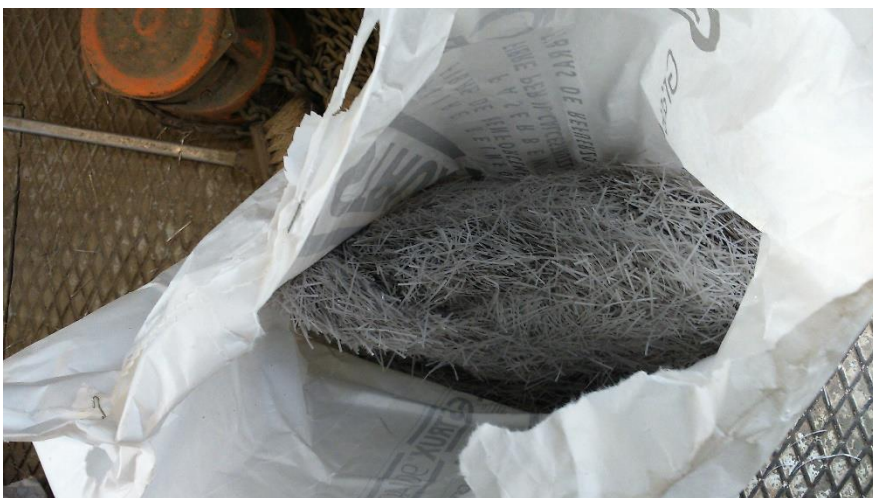
Kuva 51 Pienemmät kuitumäärät tulevat säikeissä
