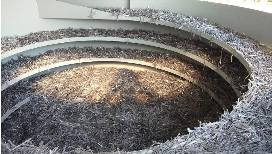
Kuva 49 Kuidut sekoitetaan betonimassaan tehtaalla omasta siilostaan
