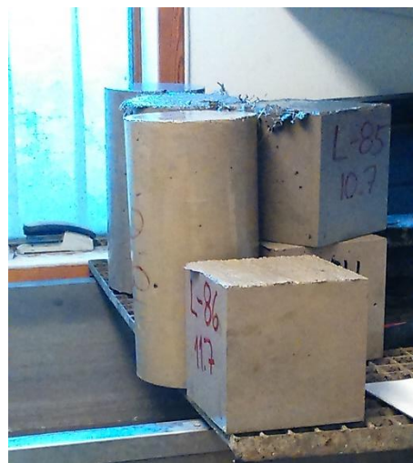
Kuva 37 Kuormituskokeeseen valmiita kappaleita
