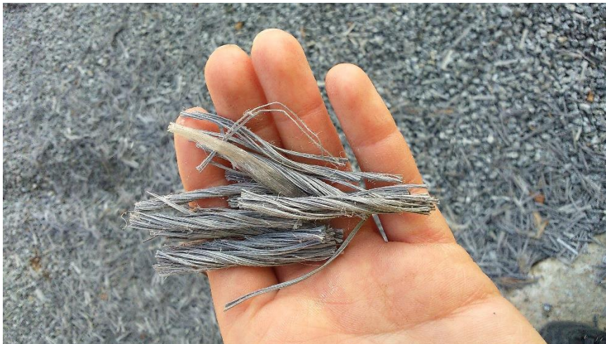
Kuva 48 Tunnelityömaalla käytettävää muovikuitua
