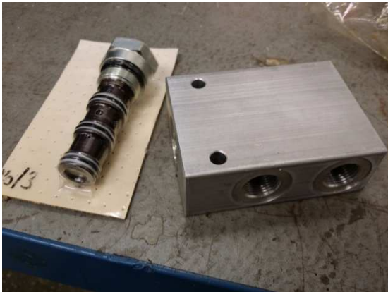
KUVA 14. Virranjakoventtiilin osat, vasemmalla patruuna ja oikealla runko
