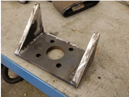
KUVA 32. Takasyylinterin tuki hitsattu kasaan
