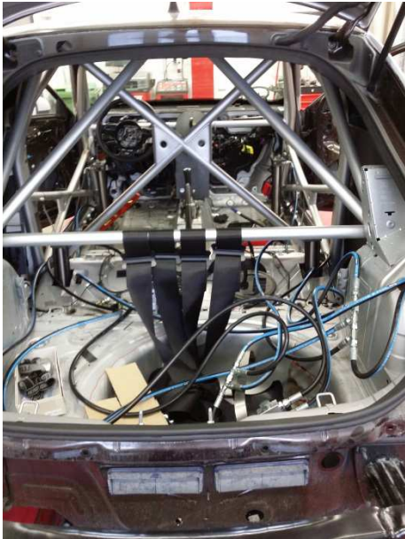
KUVA 35. Sylintereiden kytkennät valmiina
