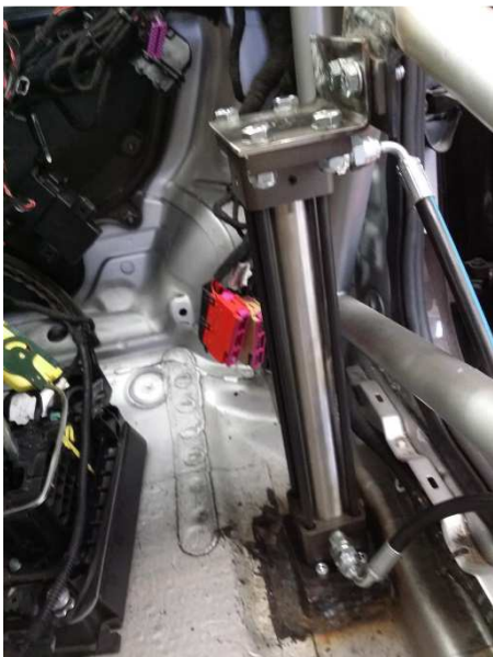
KUVA 33. Etusylinteri kiinnitetty paikoilleen ja letkut liitetty
