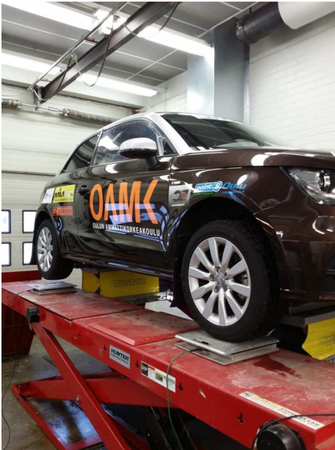
KUVA 1. Vaa'at asetettu Audin renkaiden alle
