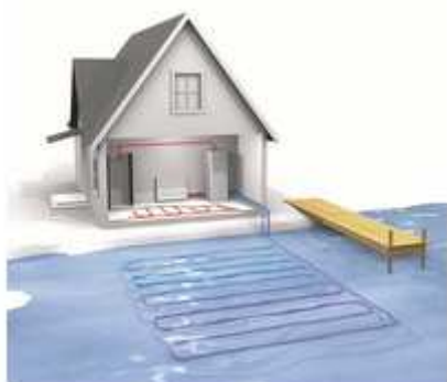
KUVA 4. Vesistöön asennettu putkisto (3)
