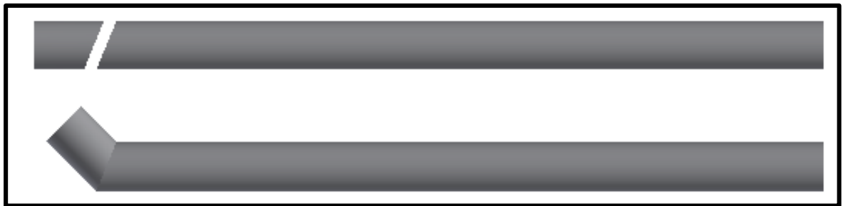
Kuvio 13. Panssariputken sahauksen ja hitsauksen periaatekuva.
