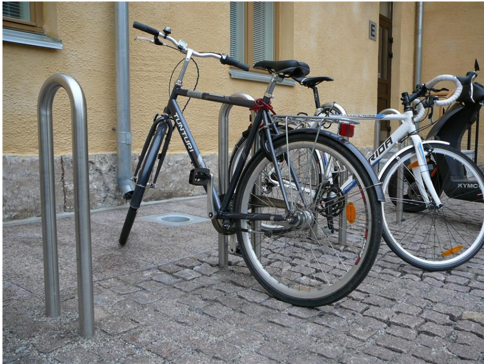
KUVA 13. Pyörän runkoon erillisellä lukolla kiinnittyvät telineet estävät pyörävarkauksia tehokkaammin (Elpac Oy 2008.)
