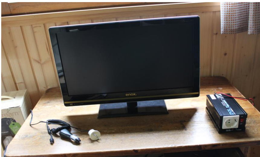
Kuva 8. Kännykkälaturi 12V, Televisio 230V, Invertteri.
