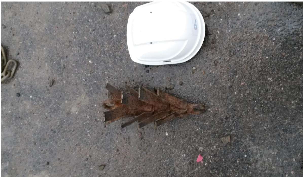
Kuva 16. Pitkäsujutuksessa saneerattavan putkilinjan puhdistukseen käytettävä joulukuusi. Kuvaaja: Teemu Kivivuori.
