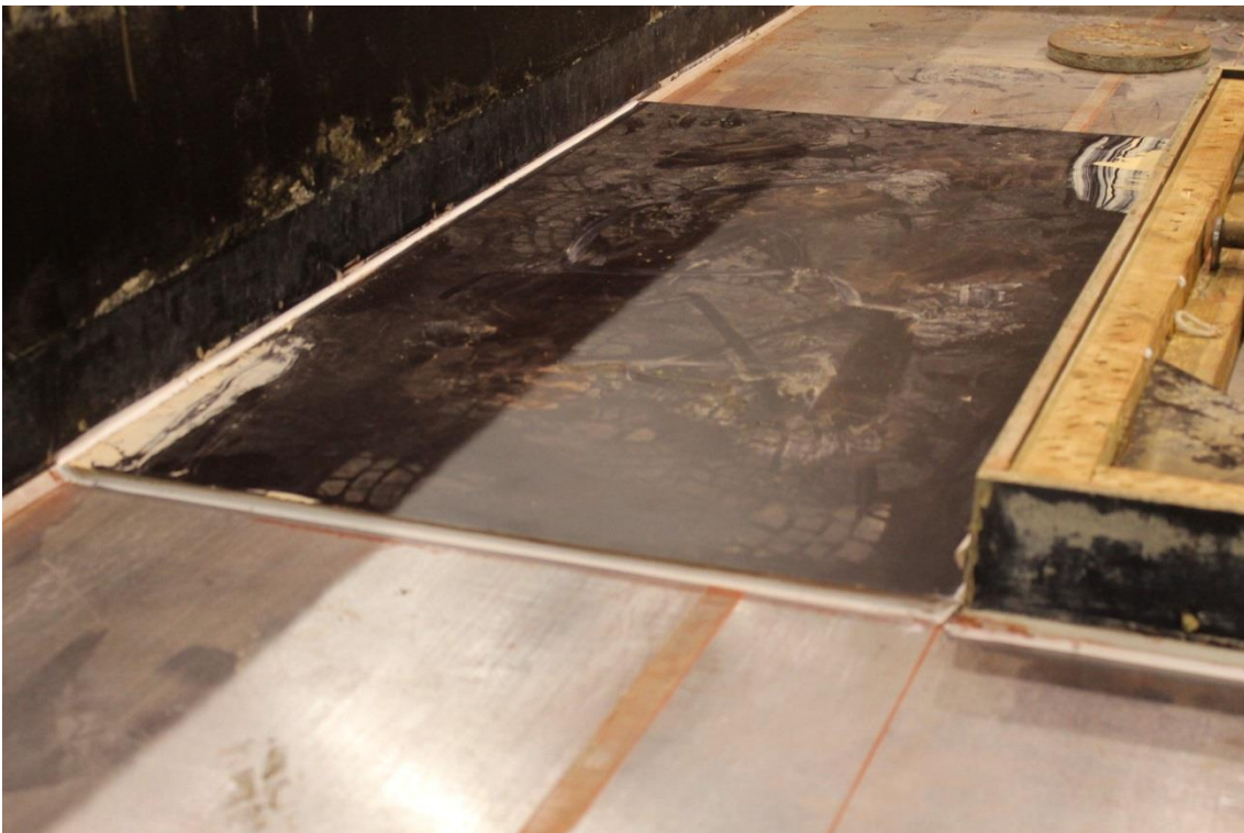
KUVA 22. Tiivistettyjä muotin ja valupinnan reunoja
