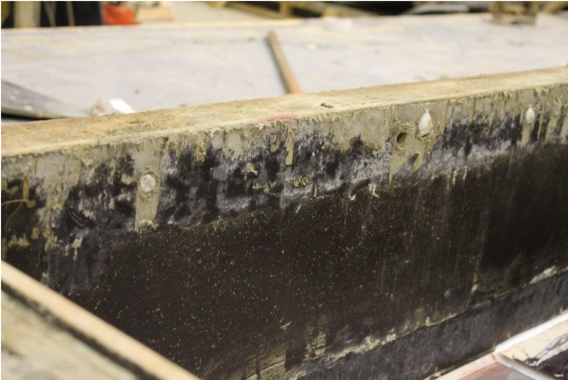
KUVA 23. Kolhiintunut ja puhdistamaton sandwich-muotin reuna
