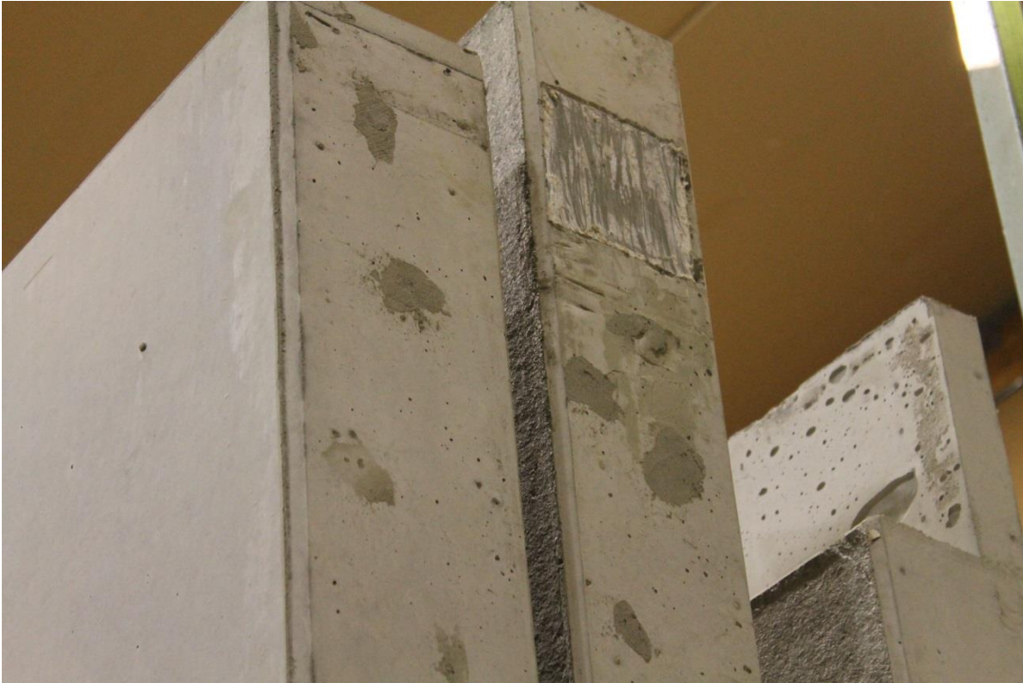
KUVA 42. Paikattuja valuhuokosia elementtitehtaalla
