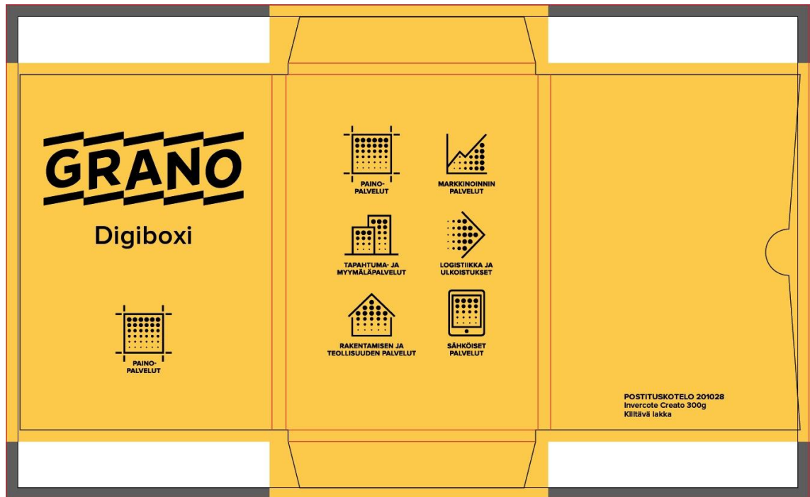
Kuva 5. Stanssilinjan päälle on tuotu kuva-aineisto, jolla voidaan tarkistaa, että aineisto sopii stanssilinjan kanssa.
