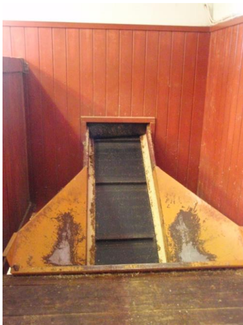
Kuva 18. Kuljetinmatto vähentää kottikärryjen kanssa liikkumista. (Hyvönen 2014.)
