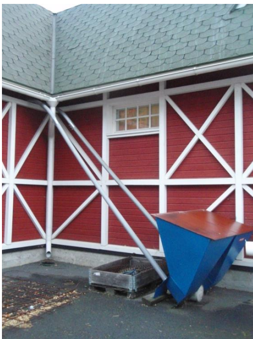
Kuva 13. Ruokinta-automaatit voi täyttää käsin tai erilaisilla kuljettimilla. (Hyvönen 2014.)
