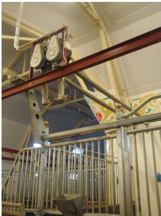
Kuva 14. Ruokintasukulan täyttäminen onnistuu kätevästi purkuruuvilla. (Hyvönen 2014.)
