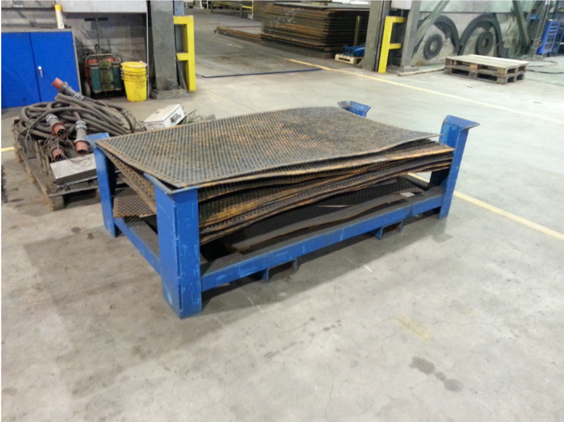
KUVA 6. Karkaisussa käytettäviä verkkoja on pinottu karkaisu-uunin viereen
