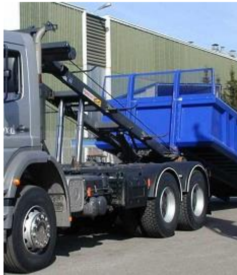
KUVA 4. Vaijerivaihtolavalaitte (Kuljetusliike Koivisto 2015)
