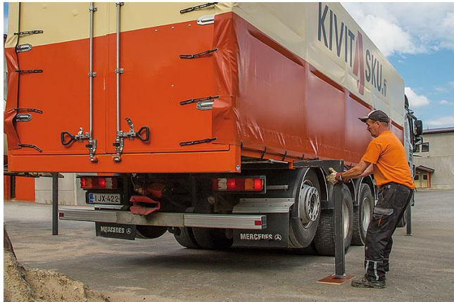
KUVA 5. Transmodi kiinnitysjärjestelmä ja apujalan poisto (Transmodi 2014)
