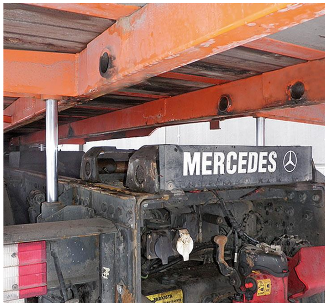
KUVA 4. Transmodi kiinnitysjärjestelmän lukkoelementit (Transmodi 2014)
