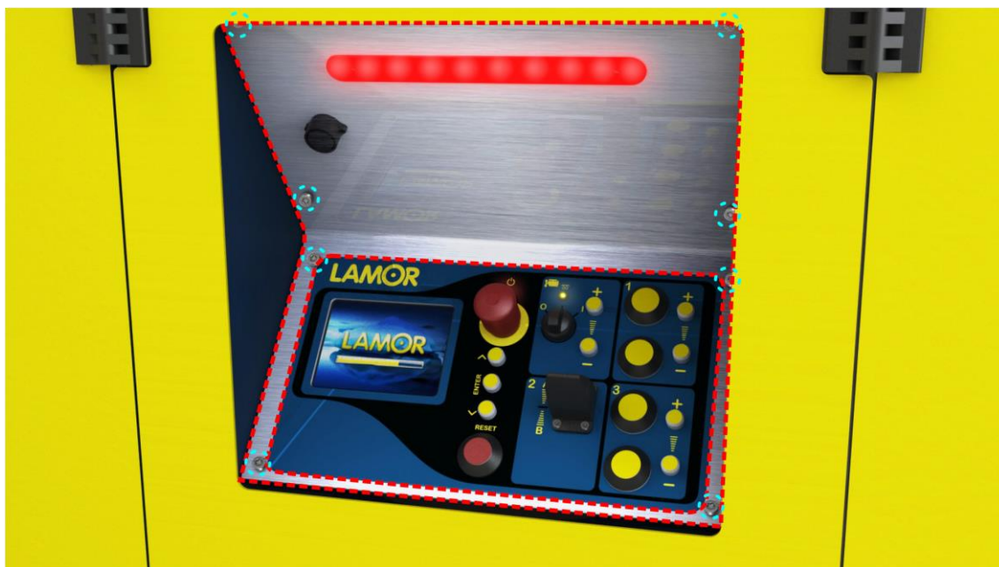
Kuva 79. Punaisilla katkoviivoilla merkattu ruostumattomasta teräksestä valmistettu levy, ja vaaleansinisillä katkoviivoilla merkatut ruuvit.
