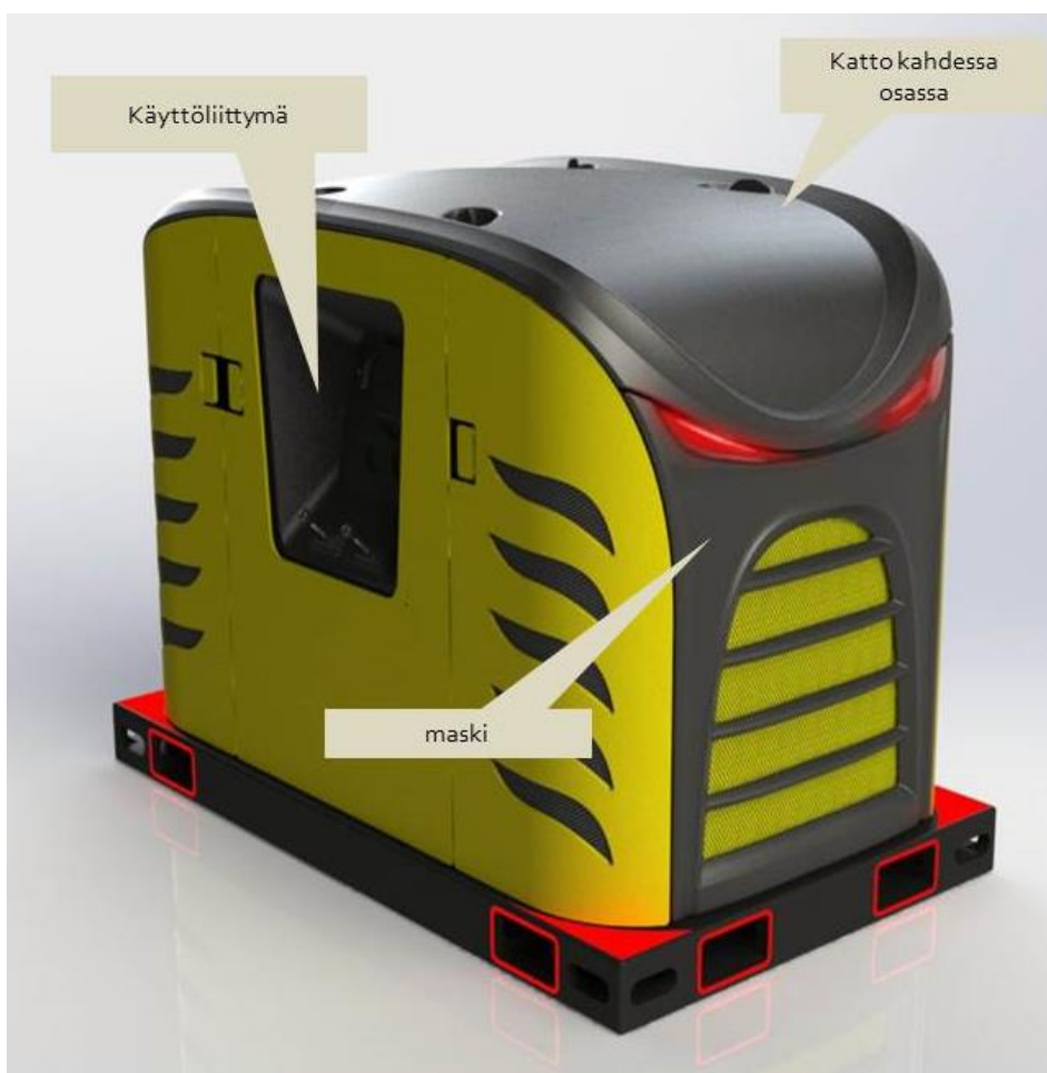
Kuva 23. Jos osat valmistettaisiin lämpömuovaamalla, toimittajan konekannalla katto olisi tehtävä kahdesta tai useammasta osasta.
