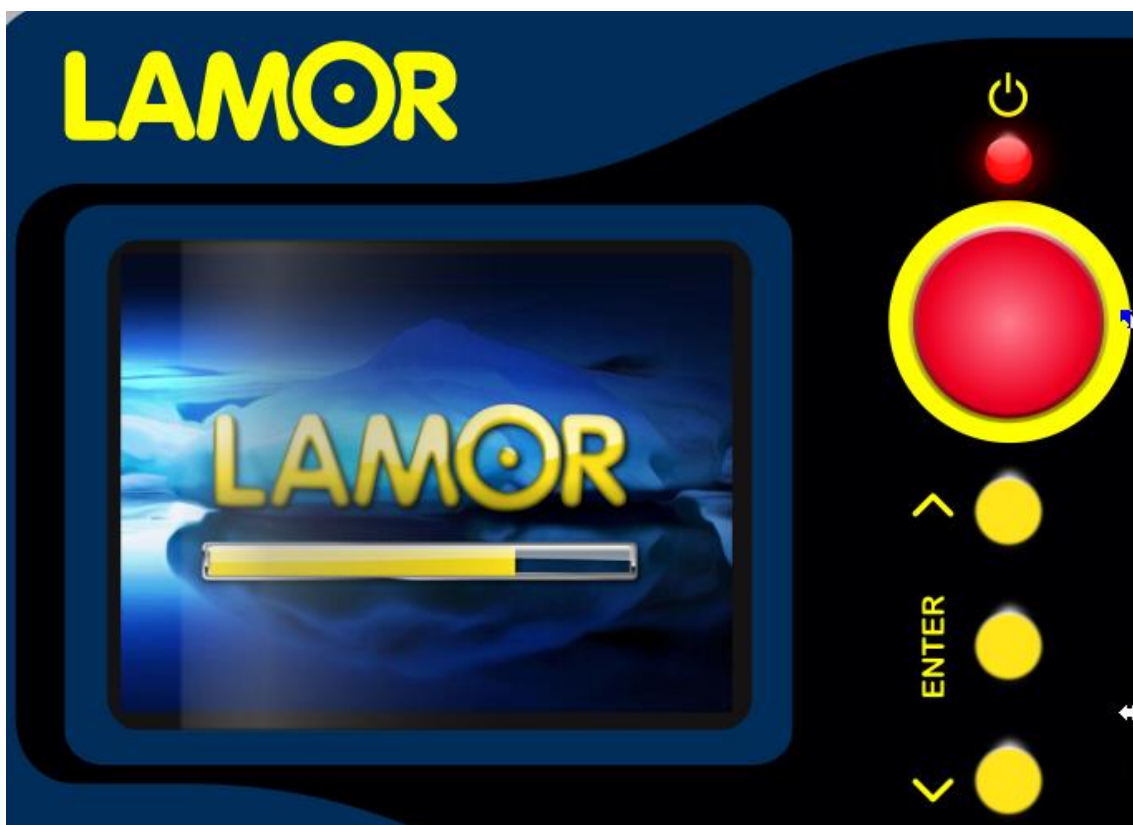
Kuva 82. Prototyypin näytön ohjaamiseen on kolme painiketta.
