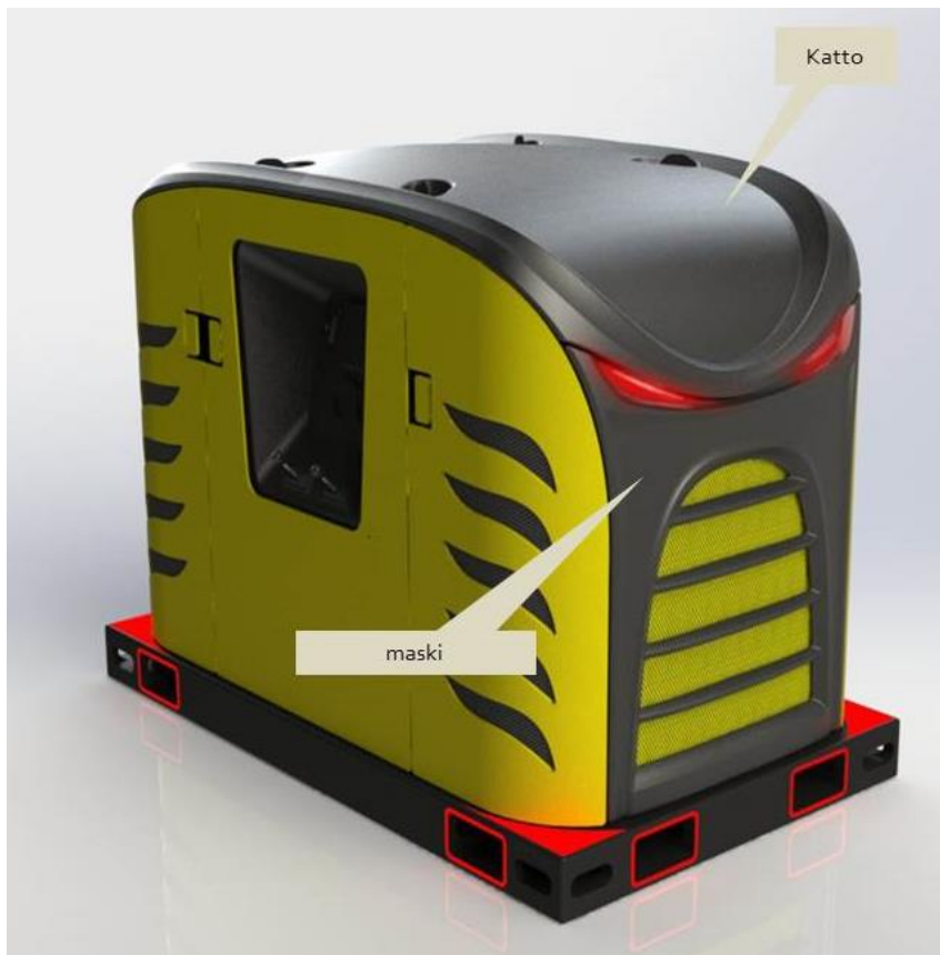
Kuva 24. Lujitemuovista tehtynä katon voi valmistaa yhdestä osasta.
