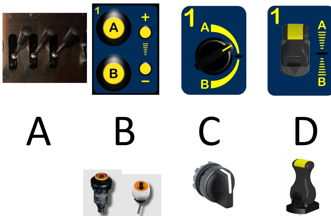
Kuva 81. A) Nykyisissä laitteissa virtausta ja suuntaa ohjataan manuaalivivulla, B) Prototyypissä virtausnopeutta ja suuntaa ohjataan neljällä painonapilla, C) hydraulisia toimintoja voisi ohjata kiertokytkimellä tai C) ohjaussauvalla.
