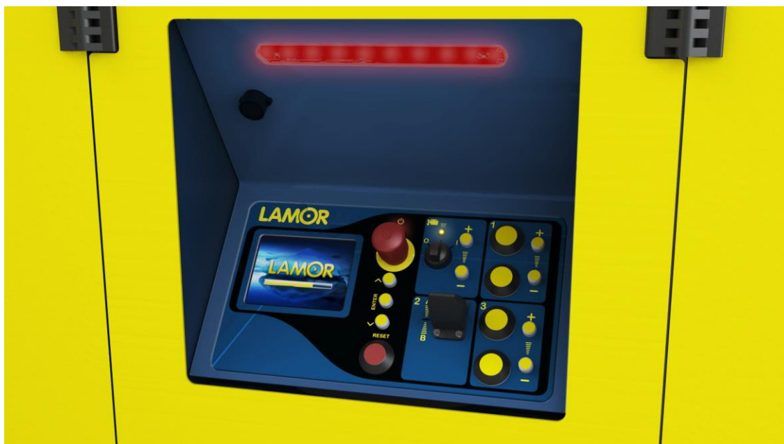
Kuva 80. Ruostumaton teräslevy voisi olla osa sinistä runkoa, ja käyttöpaneeli voitaisiin kiinnittää rungon alapuolelta niin, että päälipuolella ei olisi näkyviä kiinnitysruuveja.
