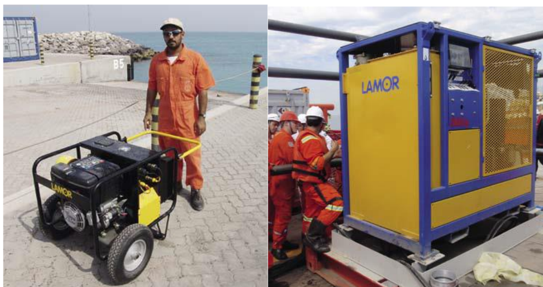
Kuva 18. Pienimmät voimanlähteet ovat ihmisvoimin liikuteltavia, isoimmat voimanlähteet liikutellaan nosturilla tai trukilla.
