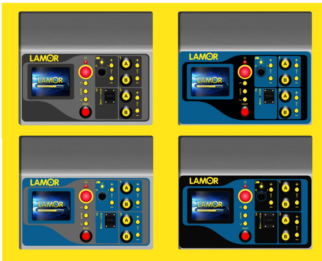
Kuva 57. Käyttöliittymän uusi komponenttiasettelu ja siitä erilaiset värvaihtoehdot.
