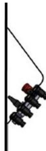
Kuva 69. Alkuperäisessä komponenttiasetelmassa painonapit olivat kaikki näytön alla ja paneelin kulma oli loivempi.
