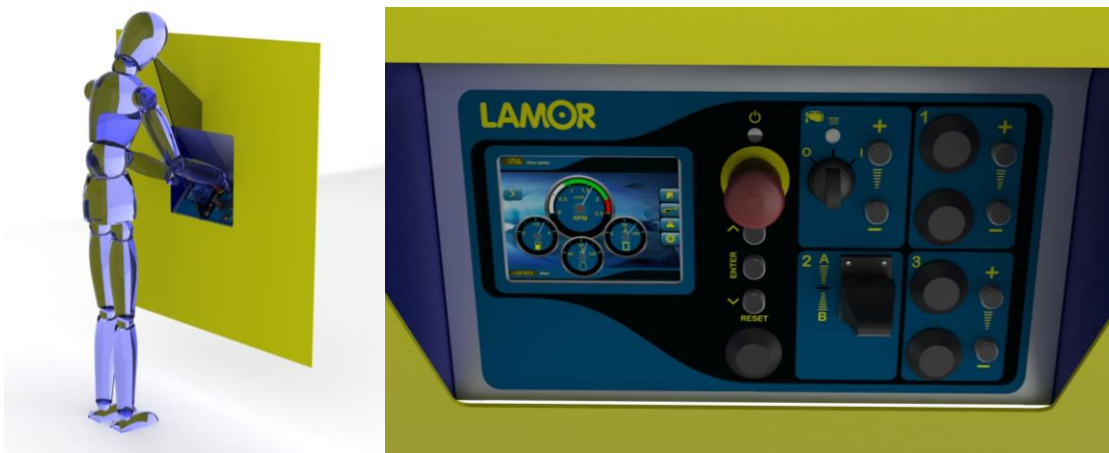
Kuva 70. 3d-hahmomallin tarkastelussa huomasin, että selkä ja niska ovat eteenpäin taivutettuina ja käsi- ja olkavarren asento on huono. Näkyvyys näyttöön ja painonappeihin on alkuperäistä suunnitelmaa verrattuna huomattavasti parempi.
