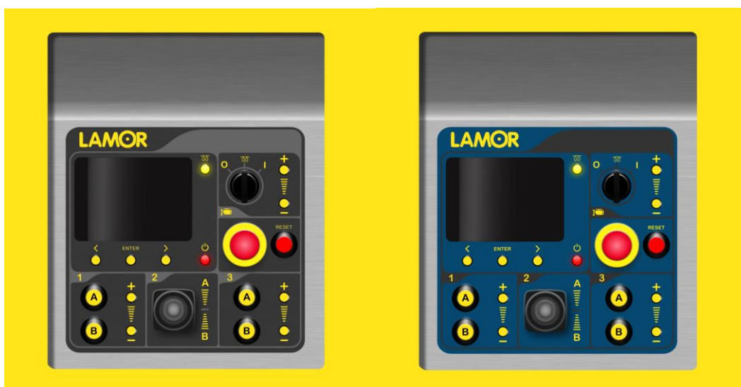
Kuva 55. Käyttöliittymään lisättiin ohjaussauva ja virtauksen suunnan symbolit vaihtui- vat nuolista A- ja B-kirjaimiksi. Kokeilin myös väri- vaihtoehtoa, jossa yksi har- maasävyistä vaihtui siniseksi.
