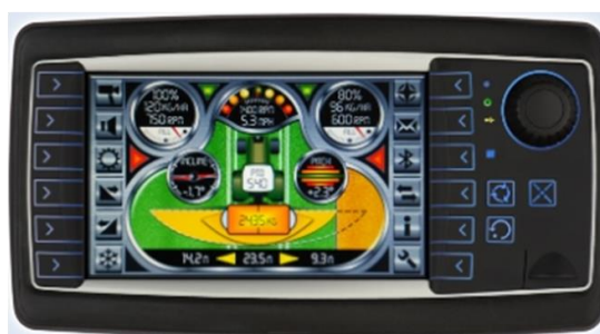
Kuva 83. Kaikkien toimintojen ohjaaminen näytöltä vaatisi mielestäni näytön käyttämiseen tarkoitettujen painikkeiden lisäämistä, tai vaihtoehtoisesti voidaan käyttää näyttöä, joka on varustettu omilla painikkeilla.
