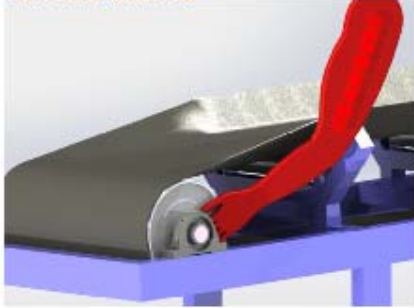
KUVA 9. Kitka- ja hiertymisvaara kuljettimen alla
