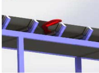
KUVA 6. Nielukohta syöttöpään pääterummun ja koneen rungon välissä
