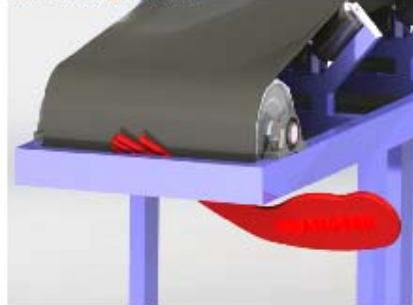
KUVA 6. Nielukohta syöttöpään pääterummun ja koneen rungon välissä
