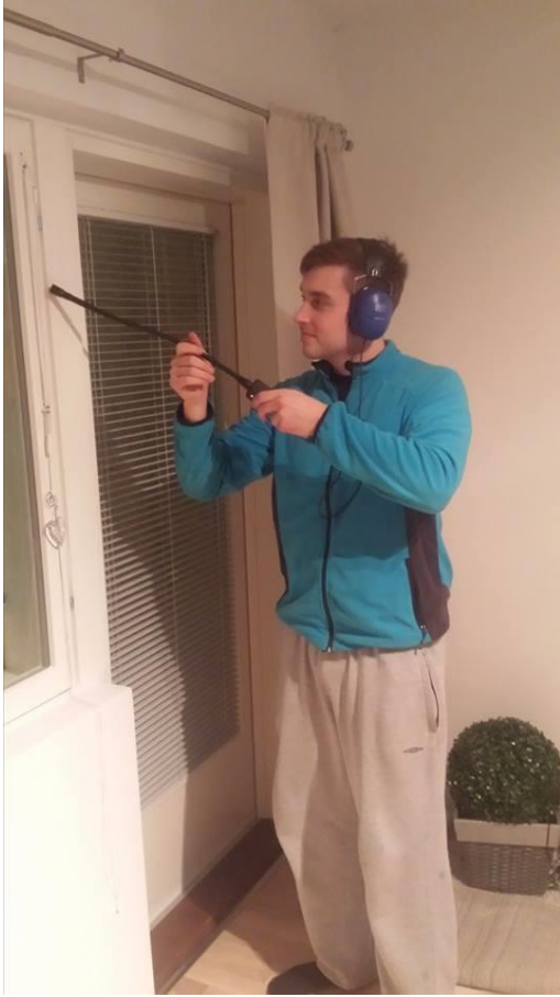
Kuva 4. Äänen vuotokohtien paikantaminen.
