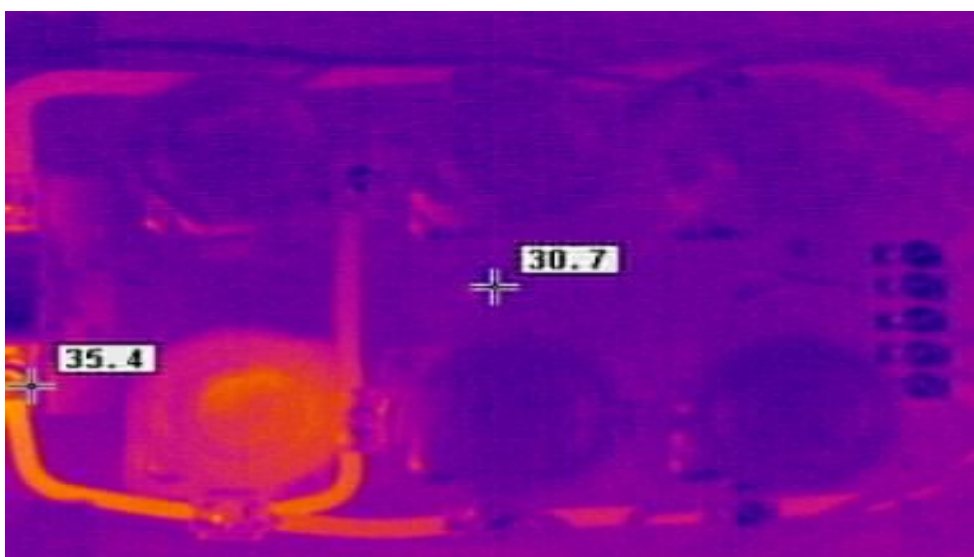
KUVA 8. Liedon sulake ja syöttöjohdin kuormitushetkellä (Kamula 2015.)
