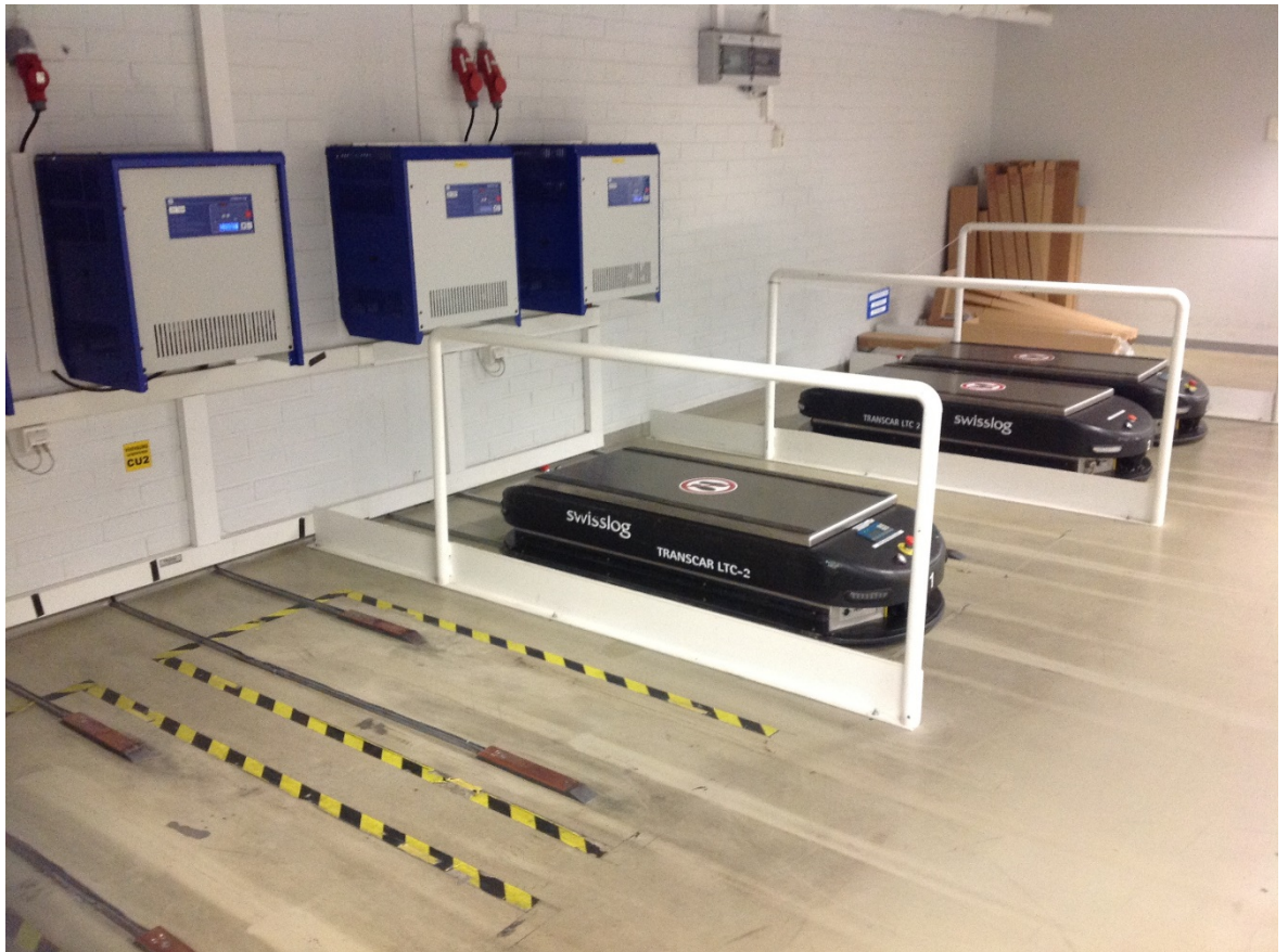
Kuvio 19. Vihivaunujen latausasema, kuvassa yksi latauksessa ja kaksi lepopaikassa
