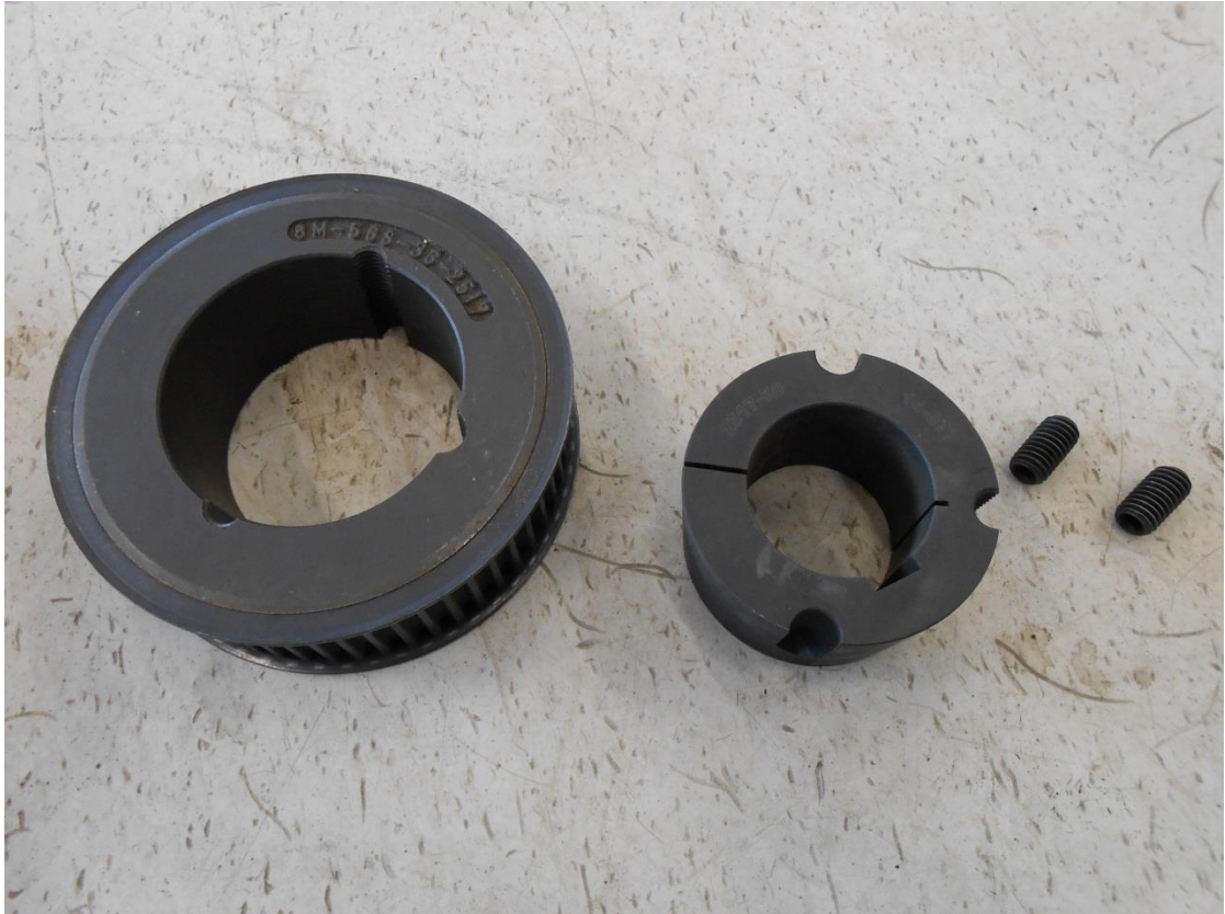
KUVA 17. Taka-akselin hammashihnapyörä ja Taper-lock holkki
