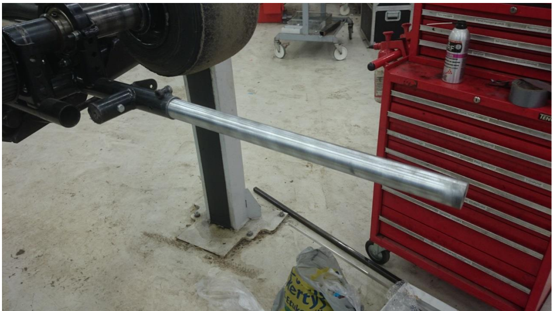
KUVA 3. Rungon sisälle asennettu vahvikeputki
