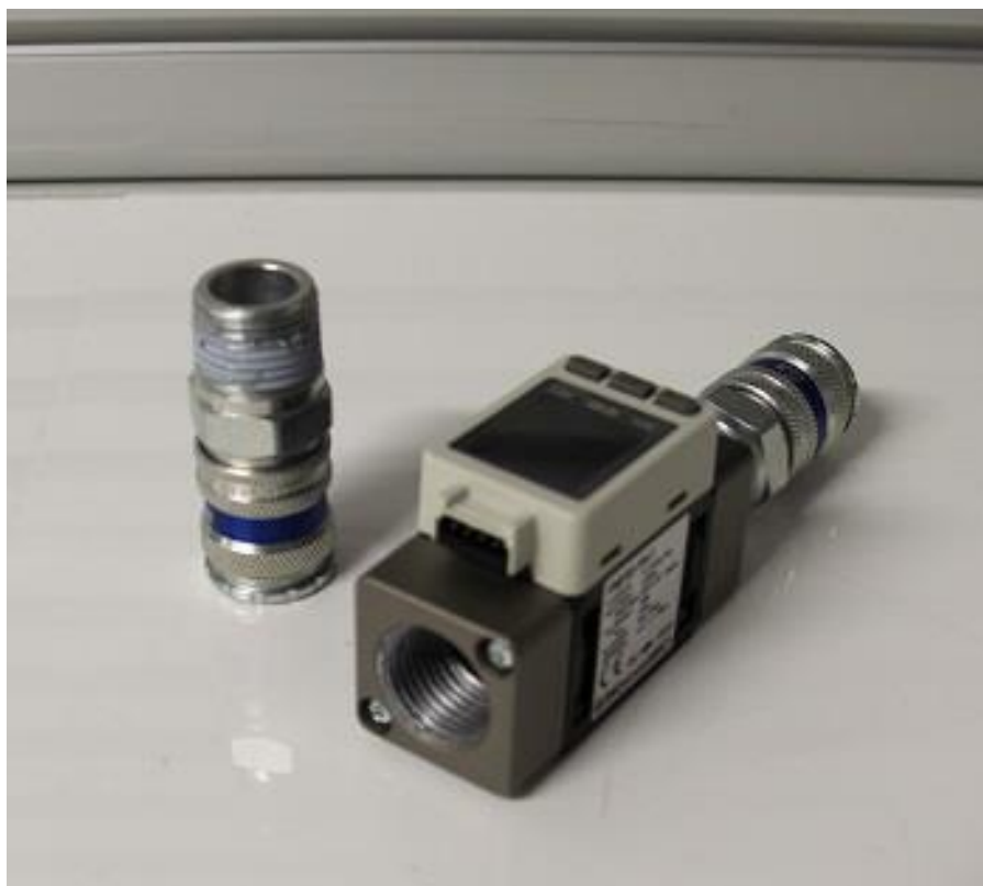
KUVA 10. Virtausmittari (Kuva: Janne Mäenpää 2015)
