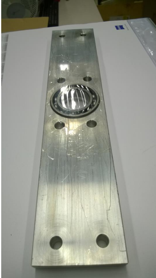
Kuva 23 Toinen laakeripesä koneistettuna ja laakeri asetettuna paikoilleen.
