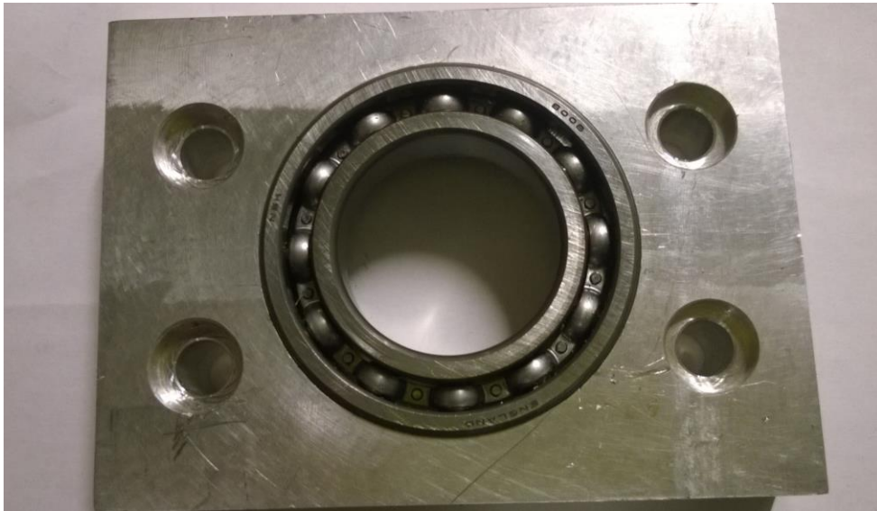
Kuva 16 Ylempässä kuvassa laakerin päällä aluslevy ja alemmassa vain laakeri
