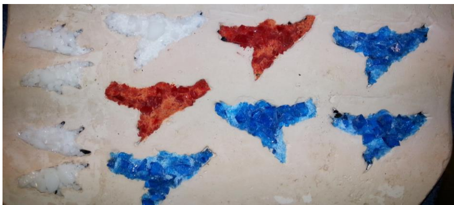
KUVA 11. Muotti täytetään kokonaan lasimurskalla. (Miettinen 2014.)
