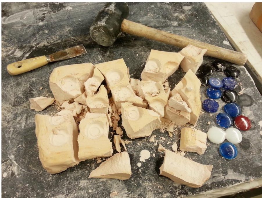
Kuva 18. Muotin purkaminen. (Miettinen 2014.)
