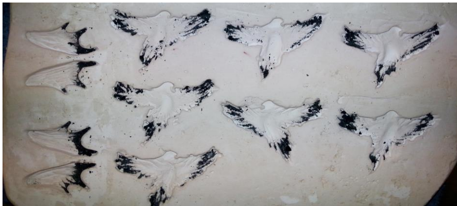
KUVA 10. Hienojakoinen lasijauhe muotin pohjalla. (Miettinen 2014.)
