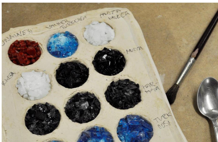
KUVA 14. Poltto- ohjelman ja lasimurskan kokeilu 1. (Miettinen 2014.)
