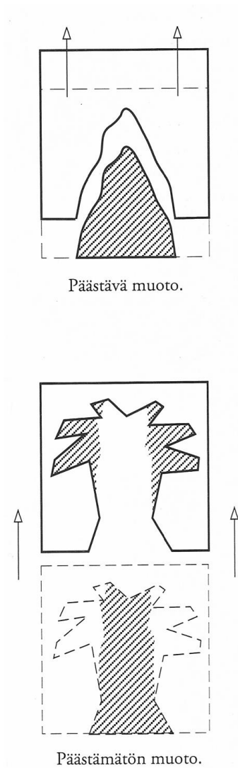
KUVA 6. Päästävä ja päästämätön muoto (Kekäläinen 1992, 34.)
