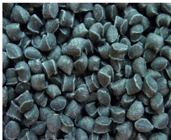
Kuva 13. Valmista muoviteollisuuden raaka-ainetta, luonnonkuitukomposiittia (Järvinen 2011). Vasemmanpuoleisessa kuvassa luonnonkuituna mäntysellua ja oikeanpuoleisessa vuolukiveä.
