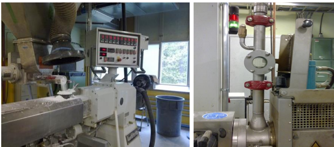
Kuvat 10-11. Kompaundointi eli sulasekoitus sekä pelletöinti (Järvinen 2011).
