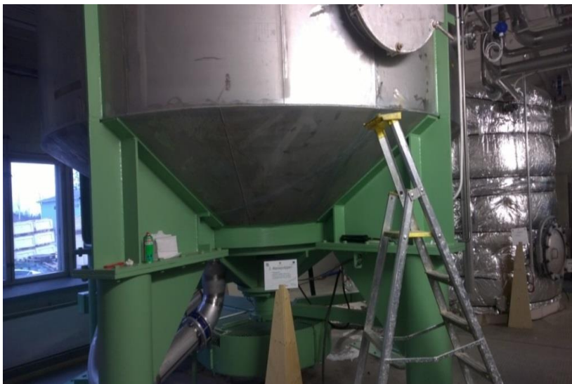
Kuva 5. Kuvassa takana puskusäiliö T-3 ja edessä massapulperi T-2.
