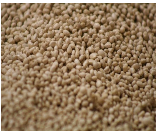
Kuva 13. Valmista muoviteollisuuden raaka-ainetta, luonnonkuitukomposiittia (Järvinen 2011). Vasemmanpuoleisessa kuvassa luonnonkuituna mäntysellua ja oikeanpuoleisessa vuolukiveä.
