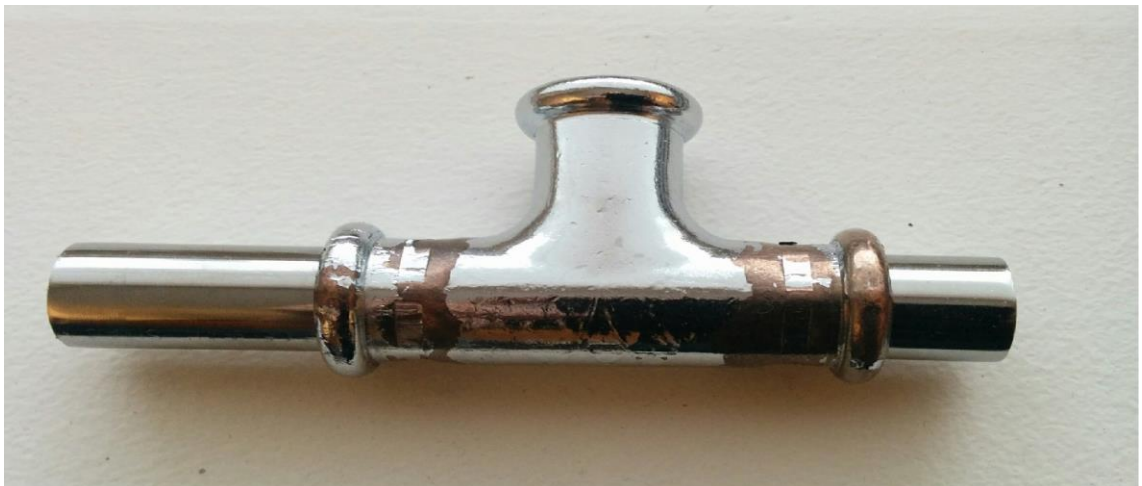
Kuva 1. Vaurioitunut M-press T-haara 15 mm.
