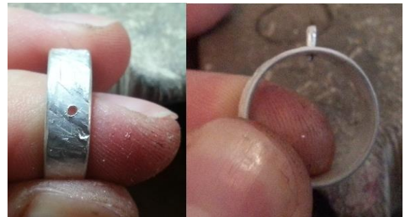
Kuva 48. Virheellinen poraus ja reiän paikkaus
