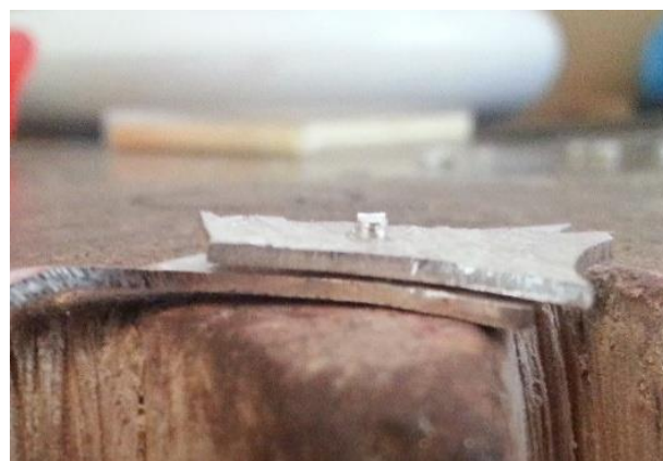
Kuva 40. Niitti asetettuna reikiin ja leikattuna oikeaan pituuteen
