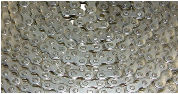
Kuva 12. Niittaamalla kasattu ratasketju
