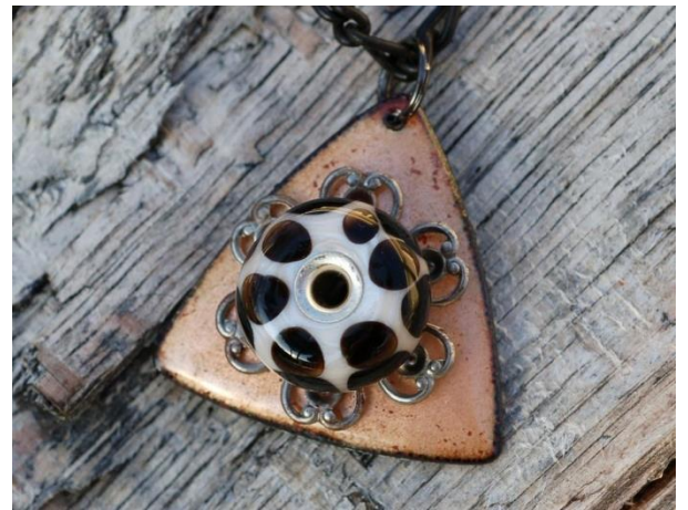
Kuva 17. Putkiniitillä koruun kiinnitetty lasihelmi
