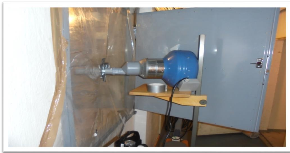
KUVA 5. Esimerkki puhaltimen sijoittelusta ja tiivistyksestä (Tuukkanen 2015)
