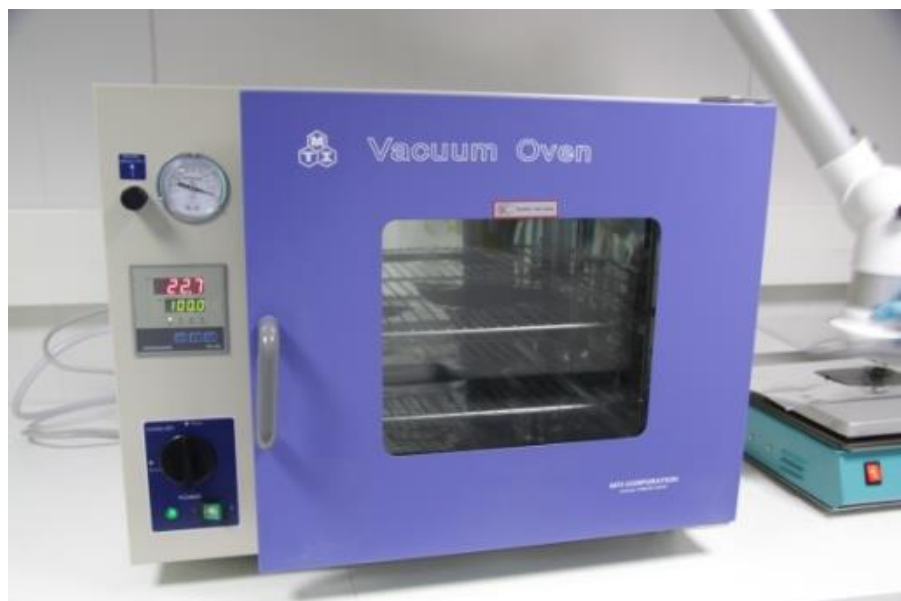
KUVIO 11. Pinnoitetun elektrodin kuivaus lämmitetyssä vakuumiuunissa
