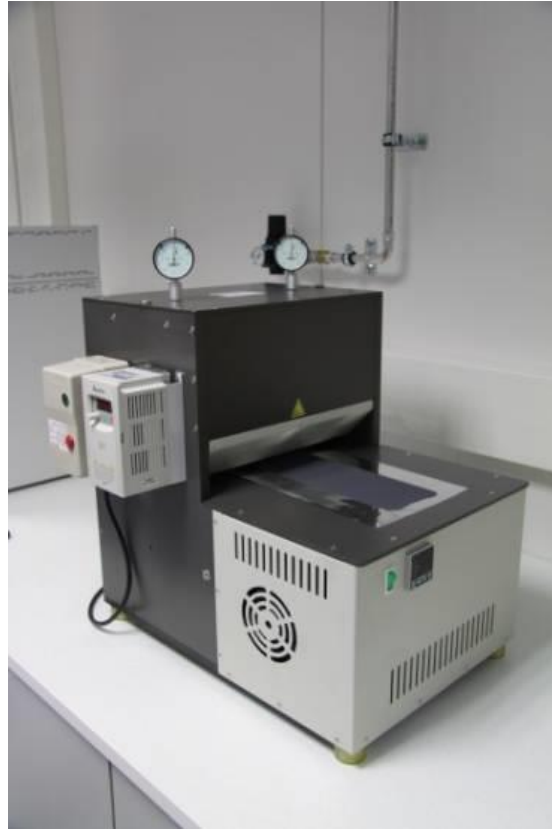
KUVIO 12. Elektroodin mankelointi kalanterointi-laitteella
