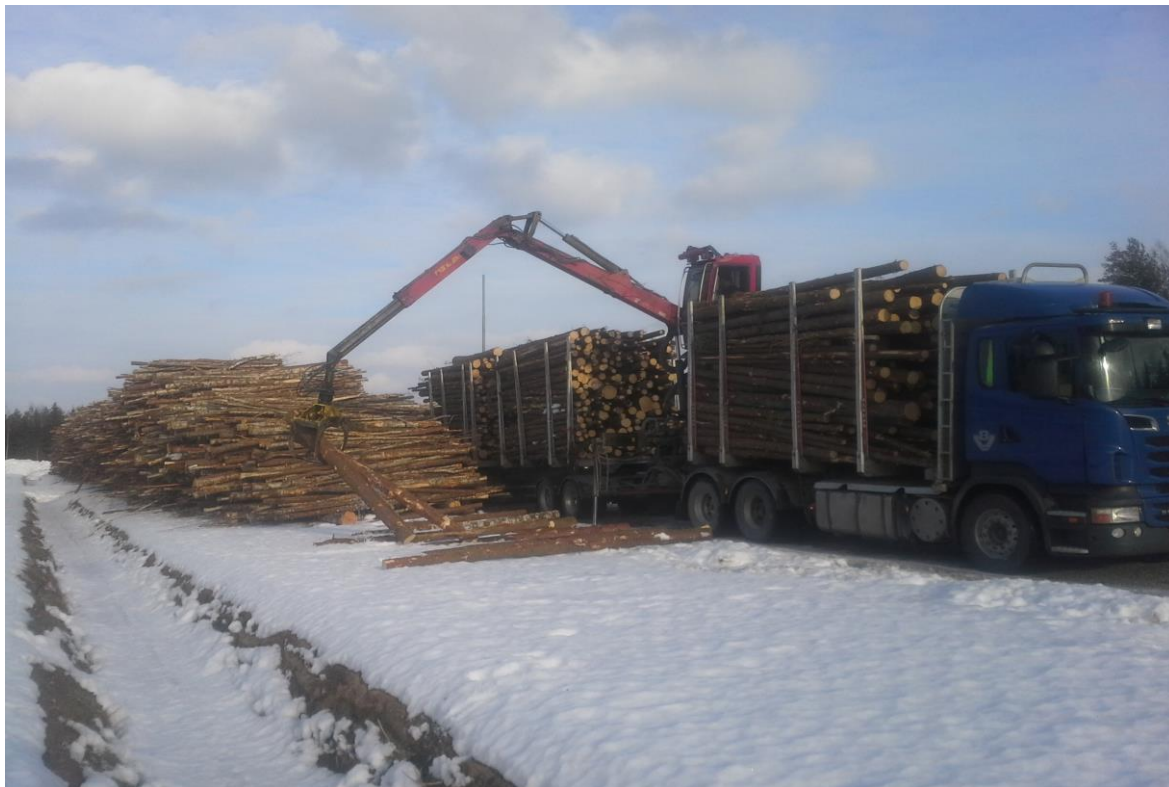
Figur 6. Lossning av kvistad energived vid terminal. (Foto: Daniel Jansson)
