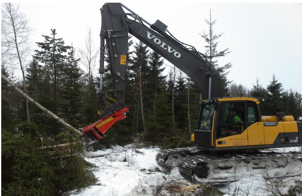
Figur 2. Avverkning med grävmaskin utrustad med giljotin. (Foto: Daniel Jansson)
