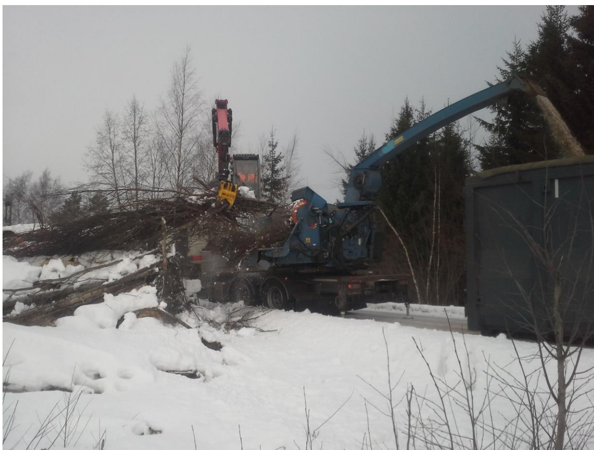
Figur 4. Flisning av helträd vid väggkant. (Foto: Daniel Jansson)
