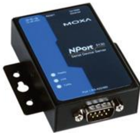
Kuva 7. Tiedonkeruujärjestelmän Moxa NPORT -sarjaporttipalvelin. [16]
