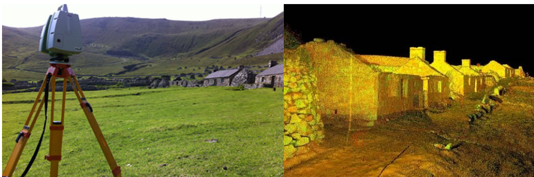
Kuvio 3. Lidar-laite ja pistepilvi.
