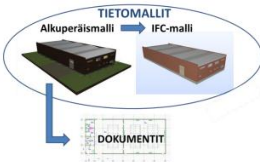
Kuva 1. Tietomallilla tarkoitetaan sekä alkuperäis- että IFC-mallia (Kulusjärvi 2012, osa 6)
