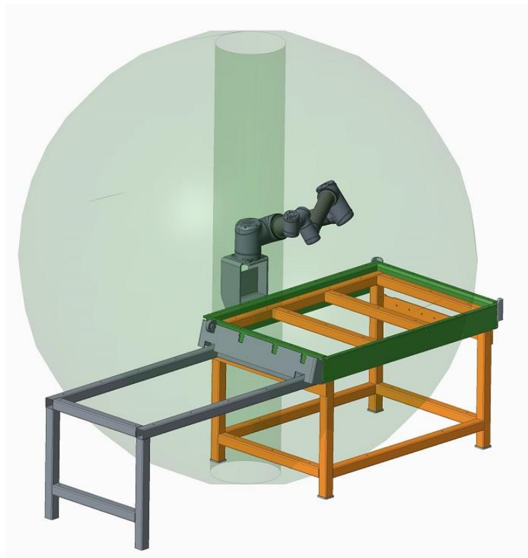
Kuva 5. Pöytä, jalusta ja robotin toimintasäde visualisoituna
