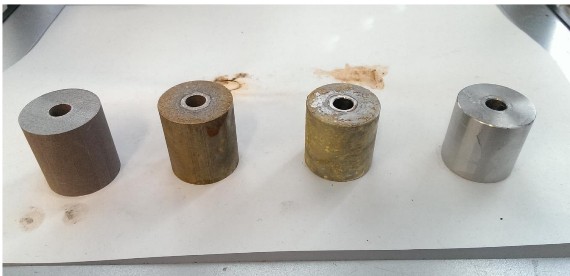
KUVA 28. Kaikki korroosiokokeessa olleet kappaleet 264 tunnin jälkeen (Jussi Ritvanen 2014.)
