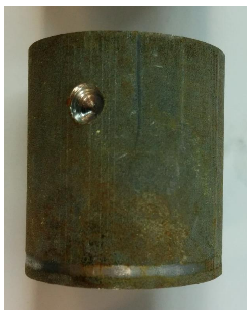
KUVA 22. Nikkelikromipinnoitettu LAM-sylinteri 192 tuntia suolasumukaapissa (Jaakko Riihimäki 2014.)
