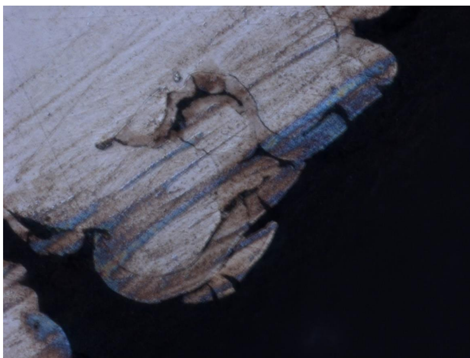
KUVA 16. Nikkelikromipinnoitetun LAM-kappaleen pinnoitteen halkeamia (Jussi Ritvanen 2014.)
