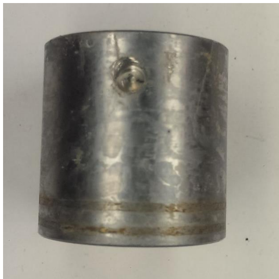
KUVA 24. Koneistettu nikkelikromipinnoitettu 24 tuntia suolasumukaapissa (Jussi Ritvanen 2014.)
