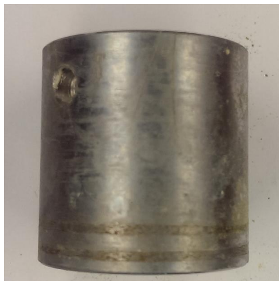
KUVA 25. Koneistettu nikkelikromipinnoitettu 72 tuntia suolasumukaapissa (Jussi Ritvanen 2014.)
