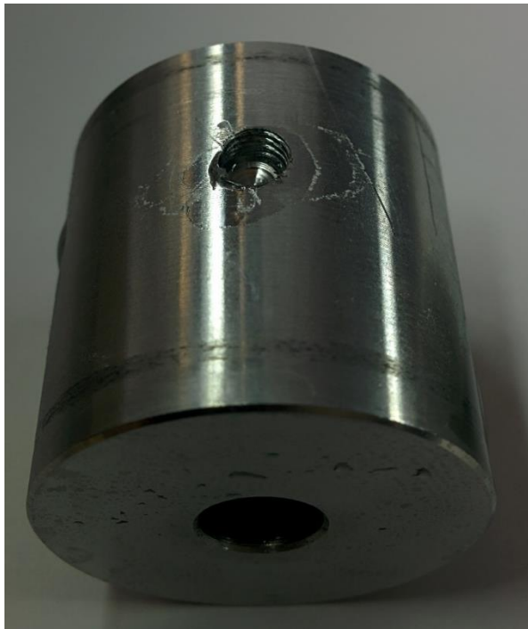
KUVA 19. Pinnoittamaton koneistettu sylinteri korroosiotestin lopuksi (Jaakko Riihimäki 2014.)
