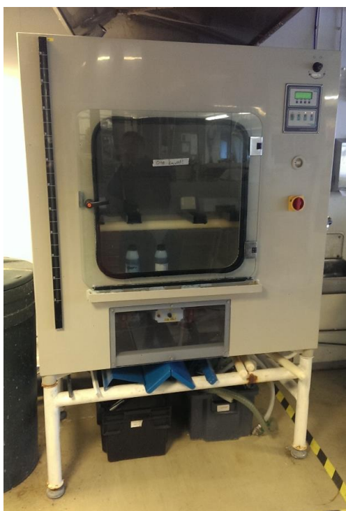
KUVA 10. Suolasumukaappi (Jussi Ritvanen 2014.)
