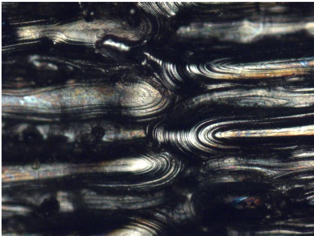
KUVA 4. Mikroskooppikuva LAM-sylinterin päältä 200-kertaisella suurennoksella (Jussi Ritvanen 2014.)
