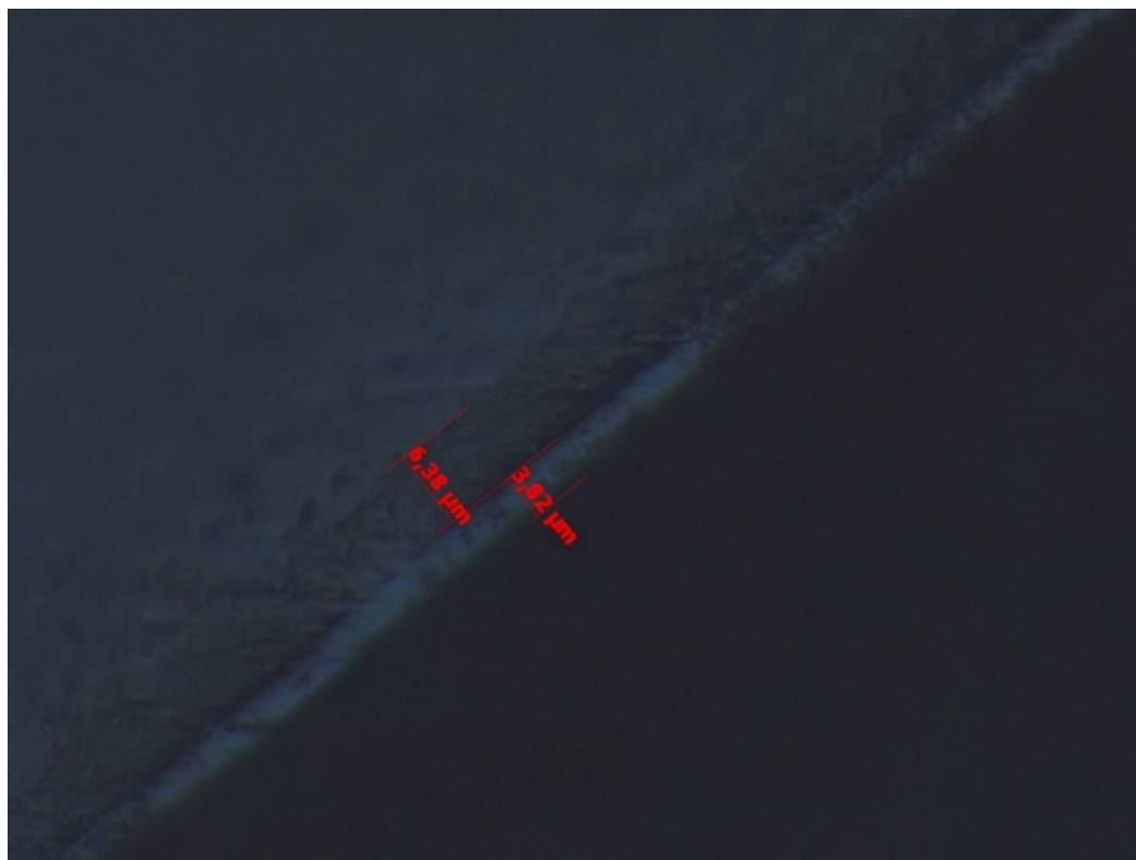
KUVA 14. Koneistetun nikkelikromipinnoitetun kappaleen poikkileike (Jussi Ritvanen 2014.)
