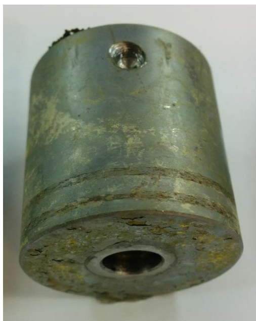
KUVA 26. Koneistettu nikkelikromipinnoitettu 192 tuntia suolasumukaapissa (Jaakko Riihimäki 2014.)
