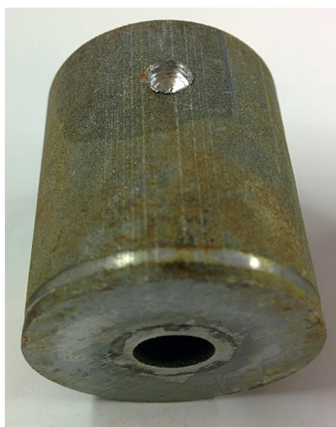
KUVA 23. Nikkelikromipinnoitettu LAM-sylinteri 264 tuntia suolasumukaapissa (Jaakko Riihimäki 2014.)
