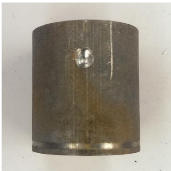
KUVA 20. Nikkelikromipinnoitettu LAM-sylinteri 24 tuntia suolasumukaapissa (Jussi Ritvanen 2014.)
