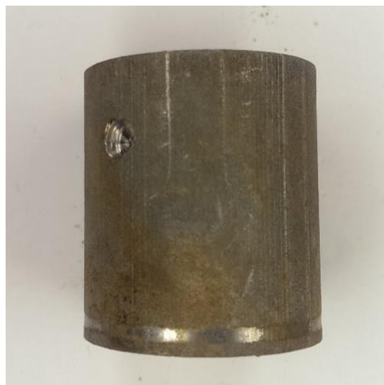
KUVA 21. Nikkelikromipinnoitettu LAM-sylinteri 96 tuntia suolasumukaapissa (Jussi Ritvanen 2014.)
