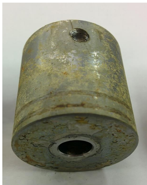
KUVA 27. Koneistettu nikkelikromipinnoitettu 264 tuntia suolasumukaapissa (Jaakko Riihimäki 2014.)
