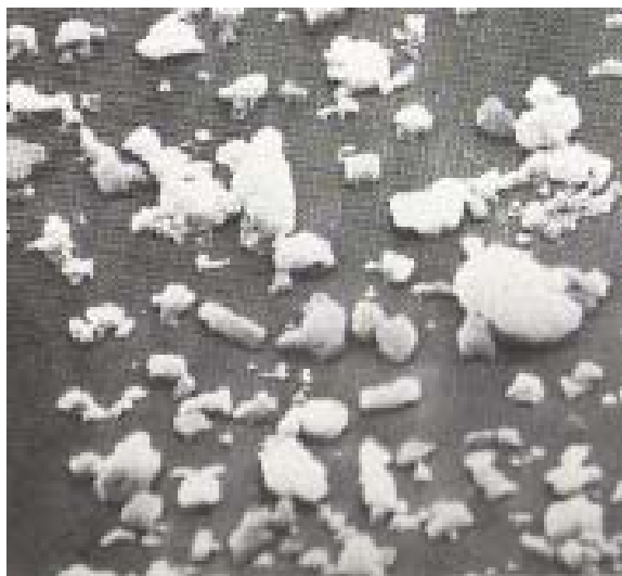
Kuva 2 Jauhettu kalsiumkarbonaatti mikroskooppikuvassa /2, s. 332/
