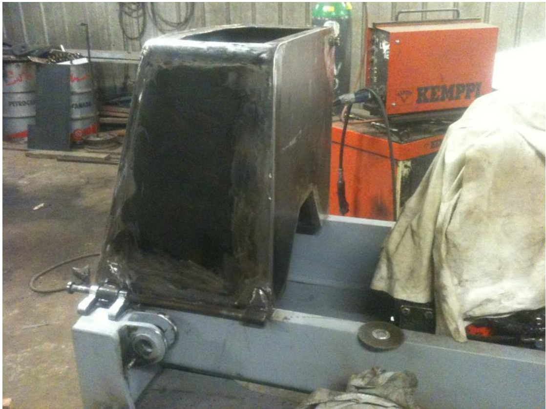
KUVA 19. Valmis öljysäiliön runko
