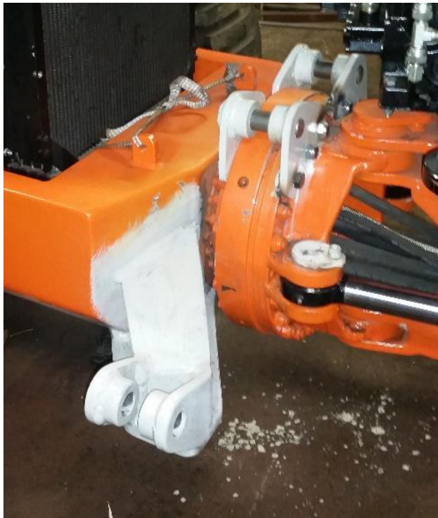
KUVA 23. Runkolukkojärjestelmän asentamista ja pohjamaalamista
