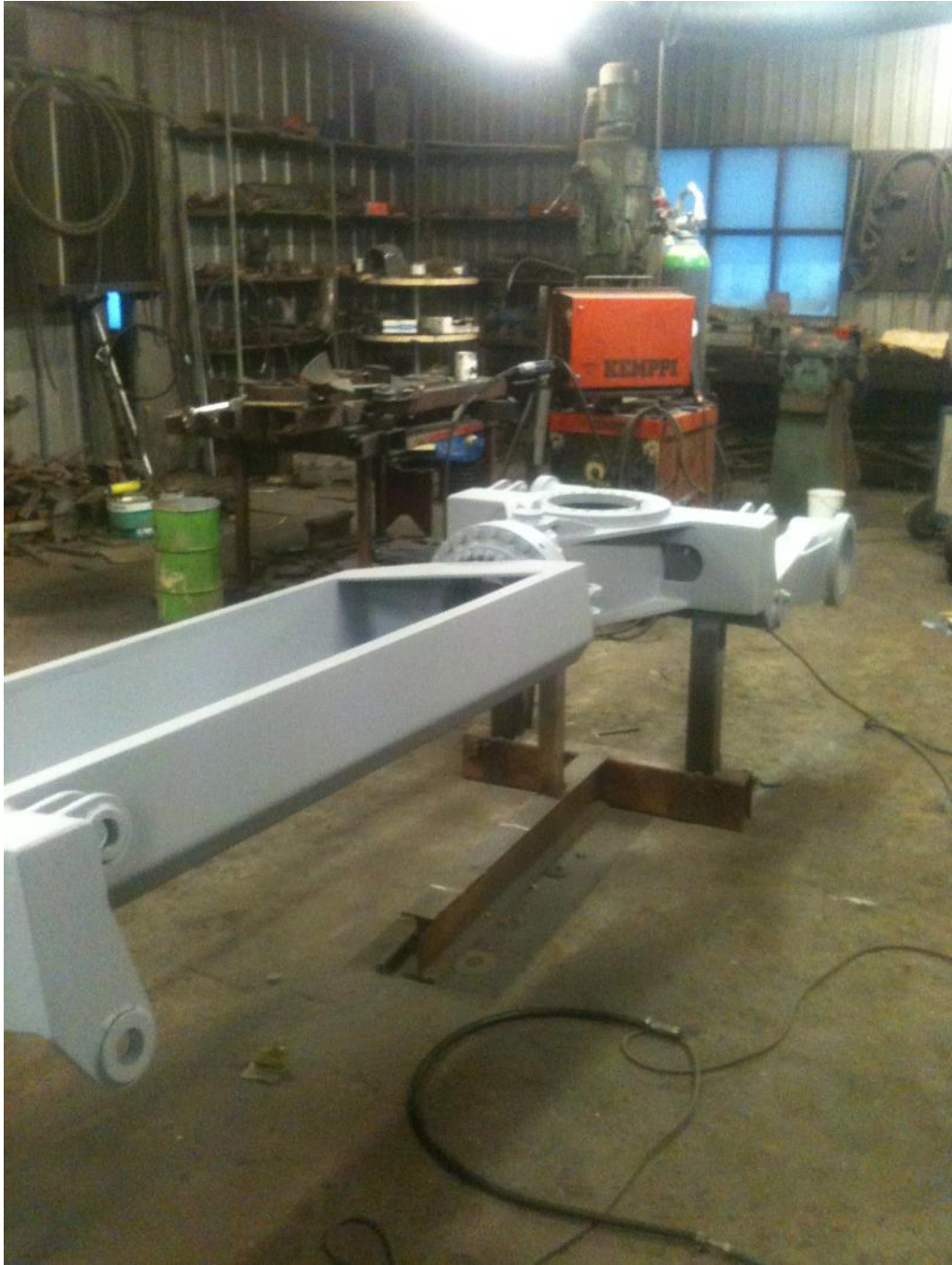
KUVA 16. Pohjamaalatun rungon kokoamista
