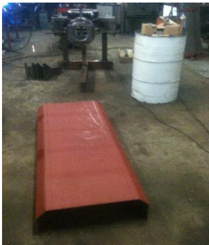
KUVA 13. Kantattu takaosarungon kotelo
