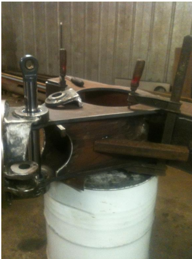
KUVA 14. Etuosarungon ja runko-ohjausnivelen kappaleiden sovittamista toisiinsa
