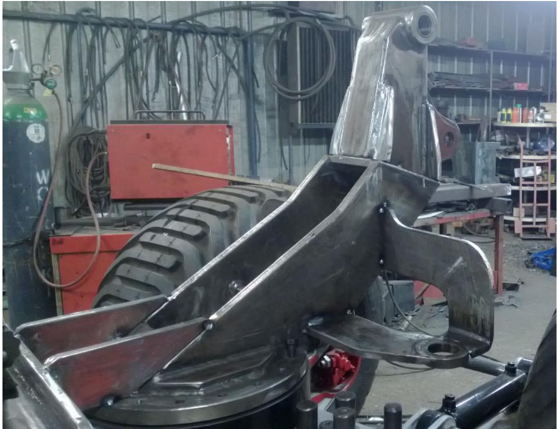
KUVA 20. Puomiston torni ja alustarakenteen valmistamista
