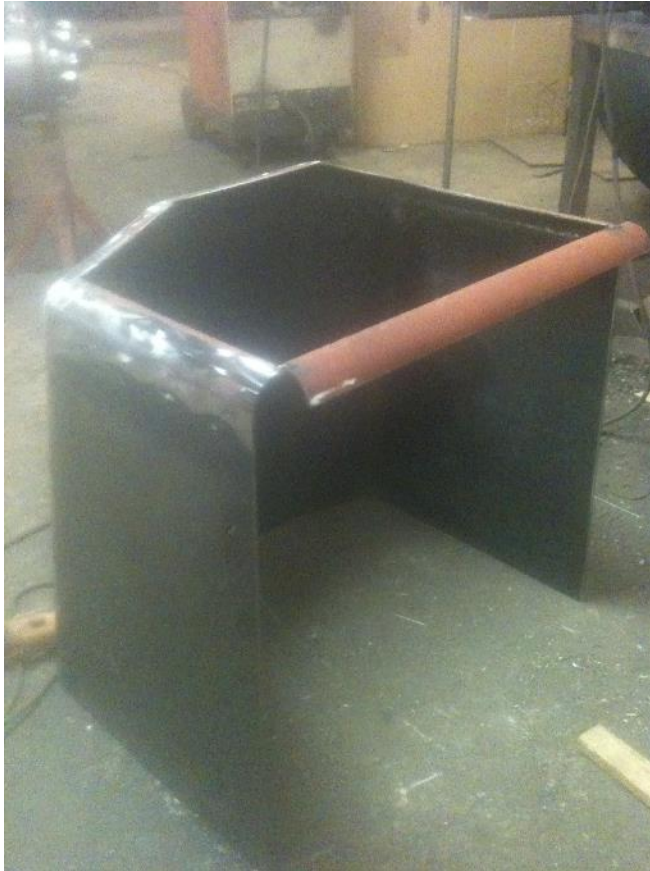
KUVA 17. Öljysäiliön kulmapyörityksien tekeminen
