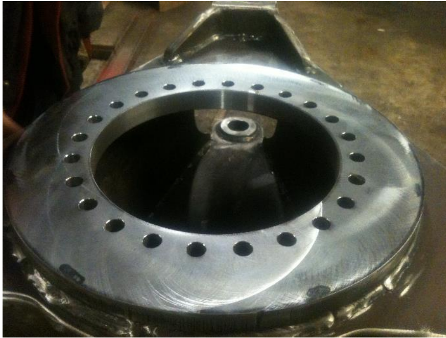
KUVA 15. Avarrus – koneella työstetty kiinnikepanta
