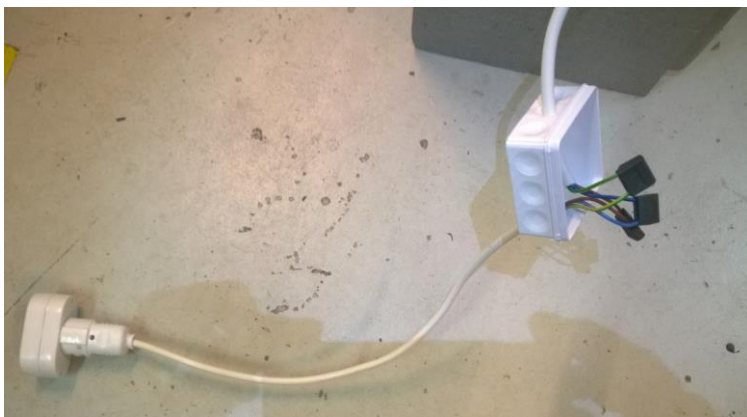
Kuva 5. Harkosta tuleva mitattava kaapeli, jakorasia ja pistorasia [4].
