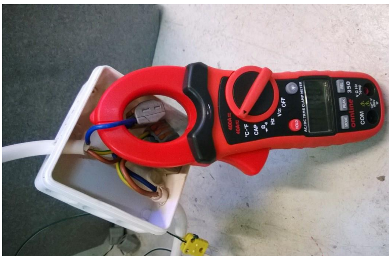
Kuva 18. Virran mittaus pihtivirtamittarilla [4].
