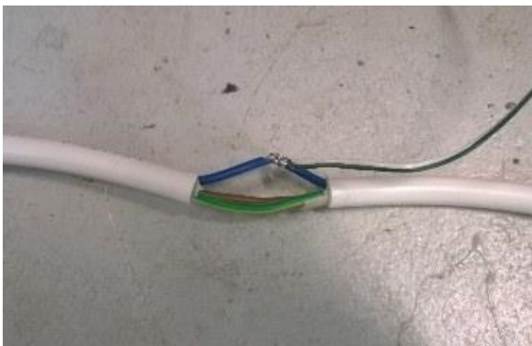
Kuva 8. Asennuskaapelin kuorittuun nollajohtimeen asennettu mittarin termoelementti [4].
