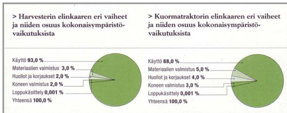
Kuva 20 Harvesterin ja kuormatraktorin elinkaaren vaiheet ja osuudet /28/
