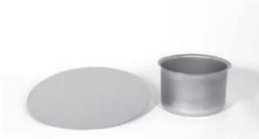
Kuva 15. Vasemmalla suurin aihio, joka on vedetty oikealla olevaksi kupiksi (Kivivuori 2011, 26)
