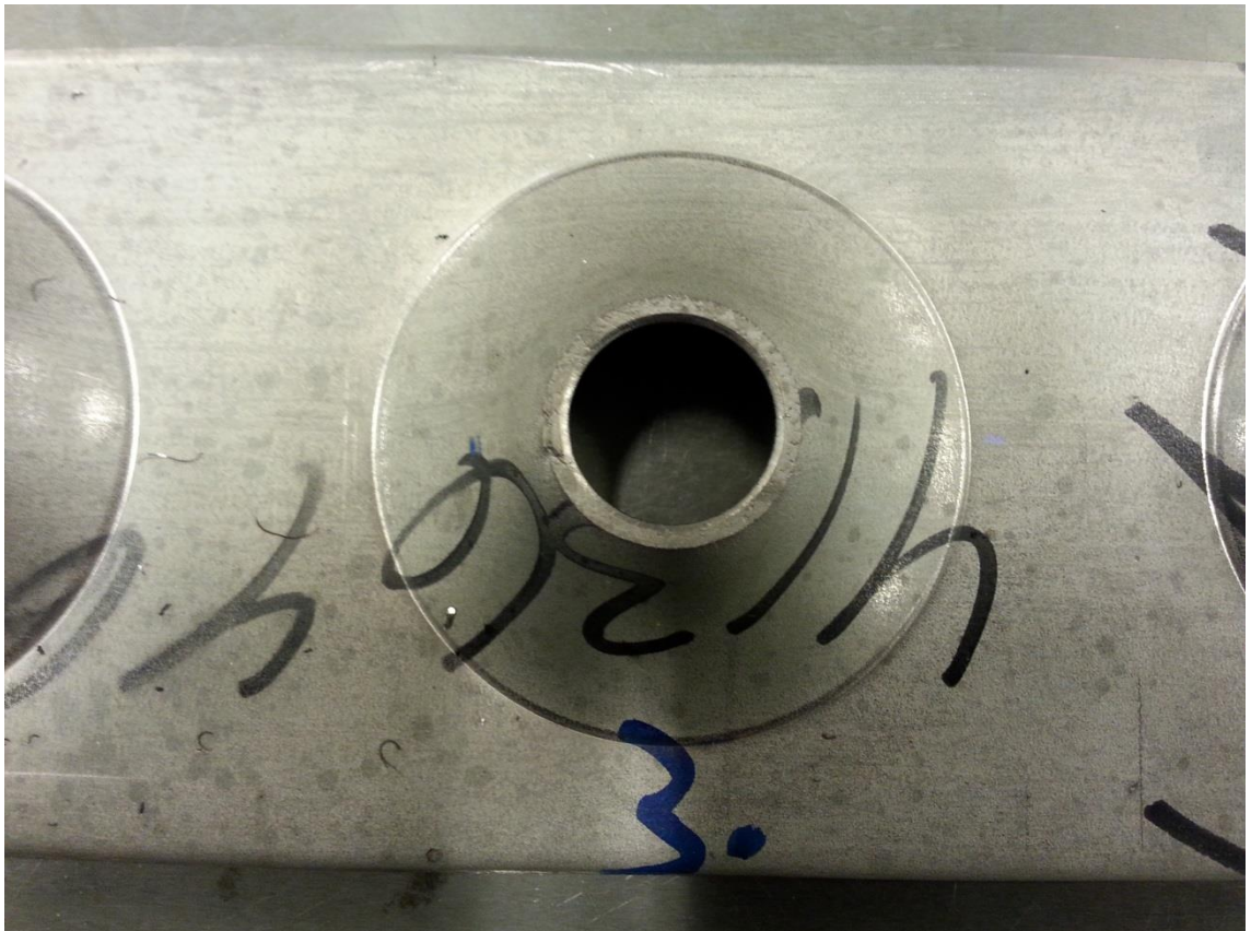
Kuva 25. Koeaiho reiänlaajennustestin jälkeen.
