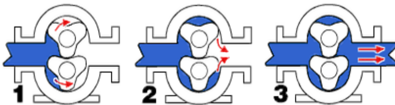
KUVA 11. Lohkoroottipumpun toimintaperiaate (5)
