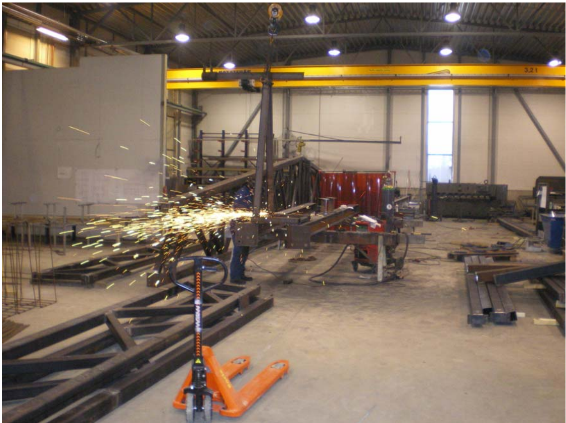
Kuvio 1: Seinäelementtien nostoapulaite työstettävänä (Kuva: Mikko Suopanki)
