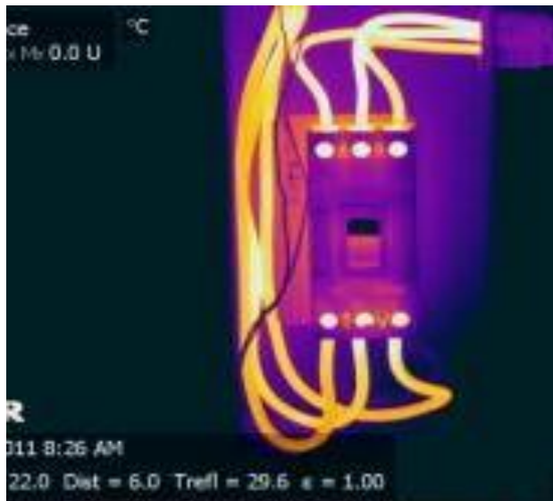
Kuvio 3. Oikosulku aiheuttaa johtimien kuumentumisen (Infrared Electrical Inspection n.d.).
