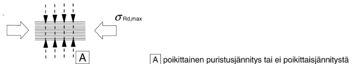
Kuva 11. Betonin puristuskaistan mitoituslujuus, kun kaistassa ei esiinny poikittaista vetoa (6)
