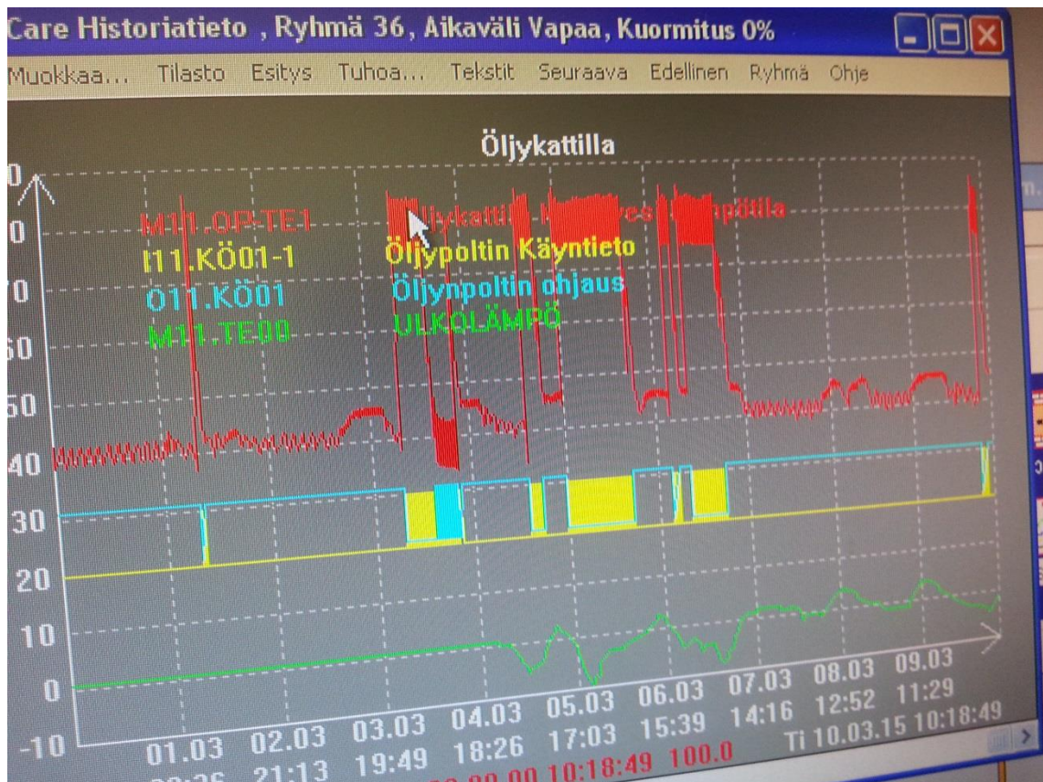
Taulukko 13. Ulkolämpötilan vaikutus öljypolttimen käynnistymiseen.
