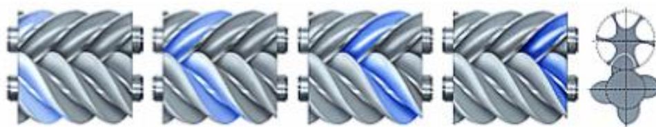
Kuva 8. Ruuvikompressorin puristusperiaate (LUT 2007).
