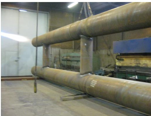
Kuvat 7 ja 8. Sillan ensimmäisen puoliskon poikkipalkkien asennus ja lopputulos.
