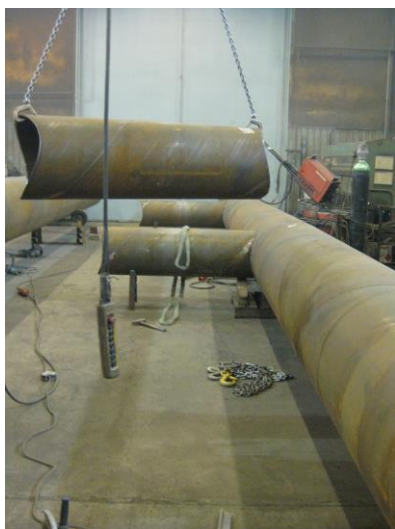
Kuvat 7 ja 8. Sillan ensimmäisen puoliskon poikkipalkkien asennus ja lopputulos.
