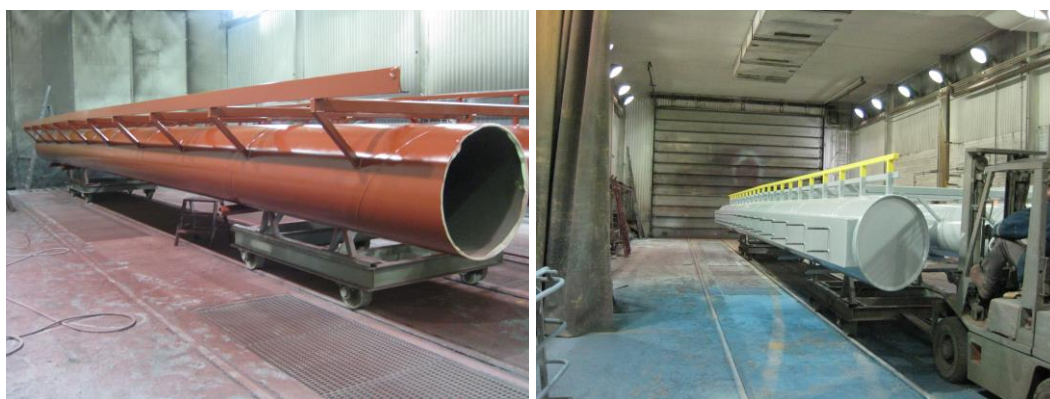
Kuvat 9 ja 10. Vasemmalla silta juuri toisen pohjamaalauksen jälkeen ja oikealla lopullinne maali pinta.
