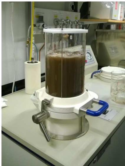
Kuvio 13. Kuitulietemassa arkkienvalmistuslaitteessa. Taustalla näkyy arkkien kuivaukseen käytetty kuivausgrilli.
