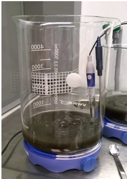
Kuvio 12. Kuitulietemassa magneettisekoittimessa. Astiassa näkyvät pH:n mittausanturi ja lämpötila-anturi.
